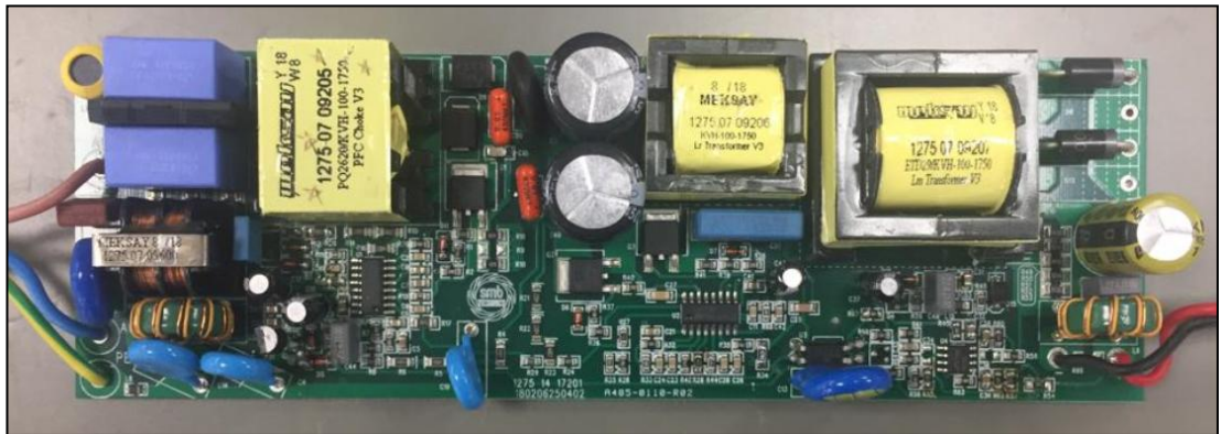
Şekil 5.1. 100 W LLC rezonant yarım köprü dönüştürücüsü test prototipi
