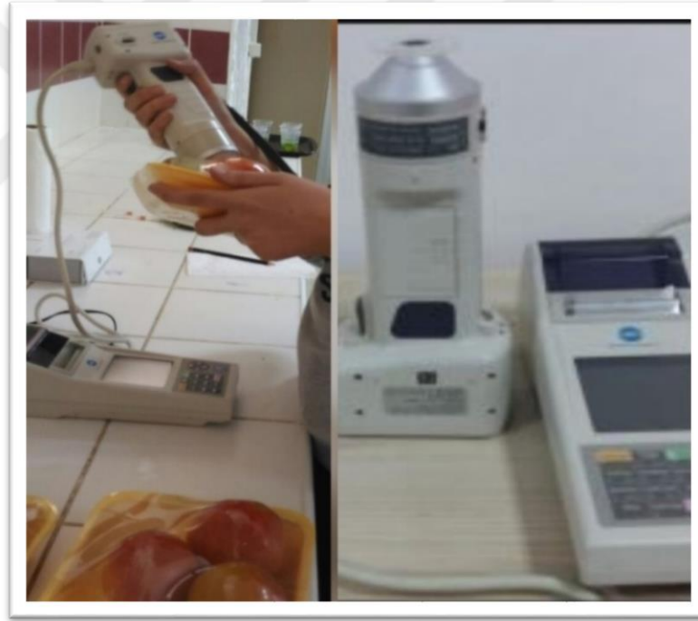
Şekil 2.8. Domateslerde meyve zemin rengi ölçümü
