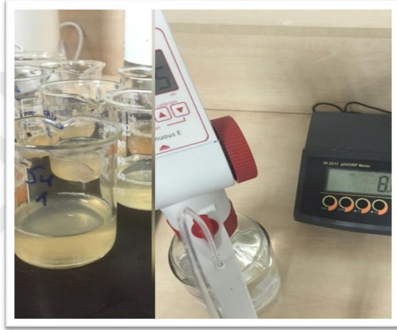
Şekil 2.7. Titre edilebilir asit miktarının ölçümü için örnek ve hazırlanması domateslerde TEA ölçümü
