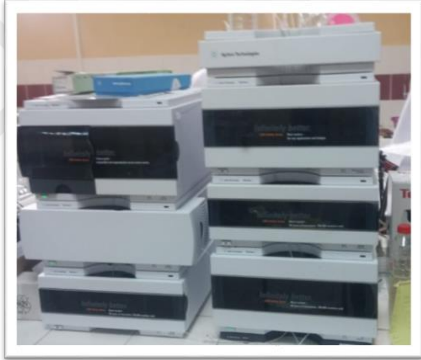
Şekil 2.9. Şeker ölçümlerinin yapıldığı HPLC sistemi
