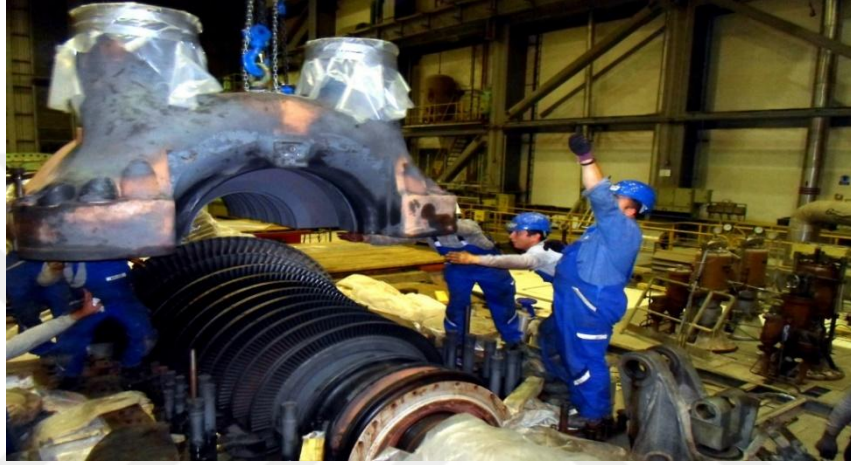
Şekil 2.13. Üst gövde kapağının demontajı [14]
