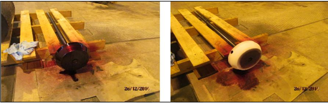
Şekil 3.21. Trip (ESV) vanası PT uygulamaları [20]
