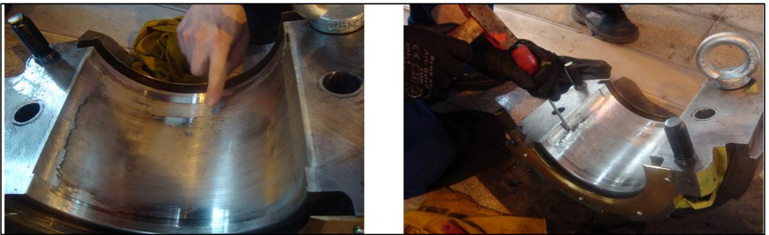
Şekil 3.16. (4) nolu yatağın demontajı ve yağ film boşluklarının açılması [19]
