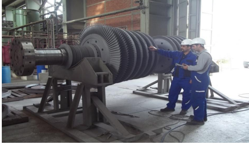
Şekil 2.18. Rotorun desteklere montajı [14]
