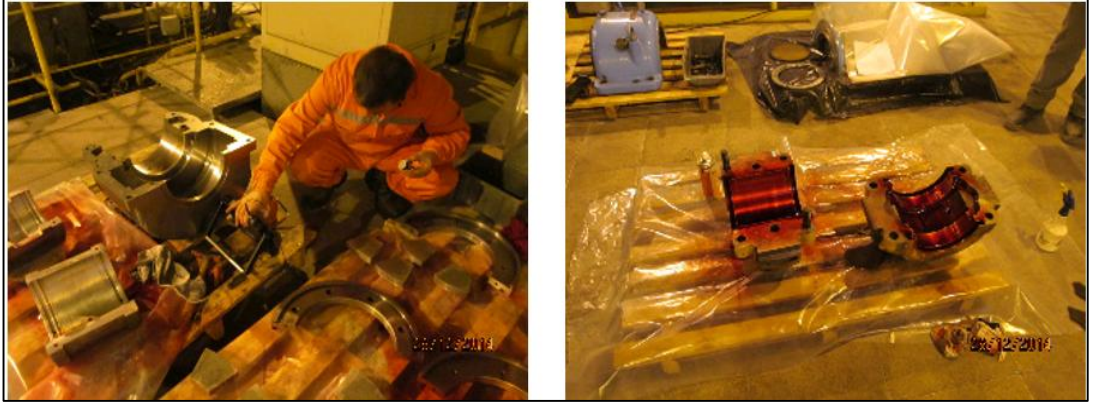
Şekil 3.18. Türbin ve generatör yataklarının PT uygulaması [20]
