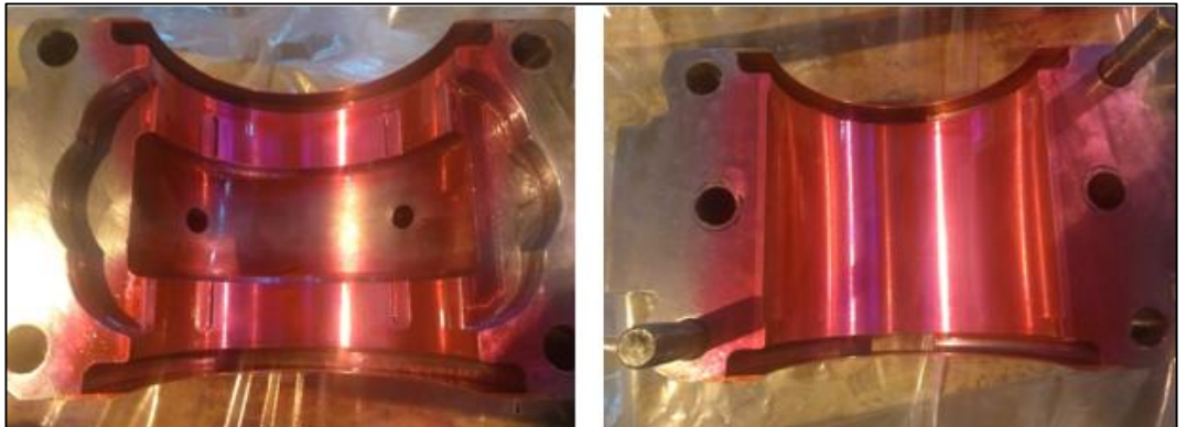
Şekil 3.30. Türbin yataklarında PT uygulamaları-1 [21]
