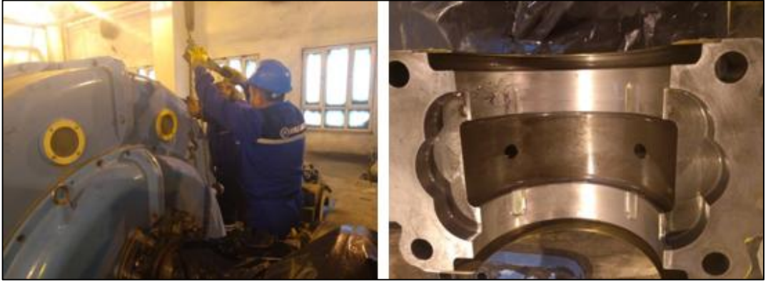
Şekil 3.29. (4) nolu yatağın demontajı [21]
