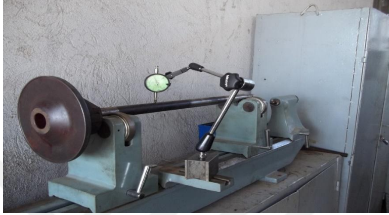
Şekil 2.29. Stem run-out ölçümü [14]
