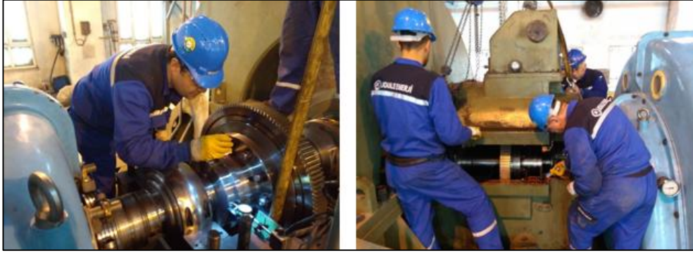
Şekil 3.38. Virör sistemi bakımı [21]
