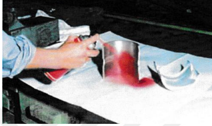
Şekil 2.6. Türbin yatağı dye-penetrant uygulaması [10]
