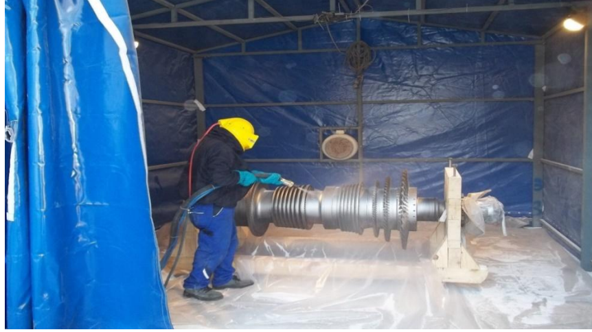
Şekil 2.20. Rotorun kumlama çalışmaları [14]
