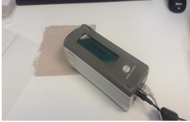
Şekil 2.16. Konika Minolta CIELAB Spektrofotometre CM 2300-d cihazı
