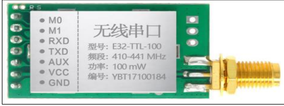
Şekil 4.8. 433Mhz E32-TTL-100 LoRa SX1278/SX1276 RF Alıcı Verici
