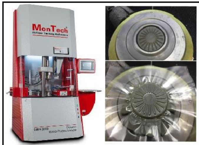
Şekil 1.19. Örnek bir RPA cihazı ve kalıbı
