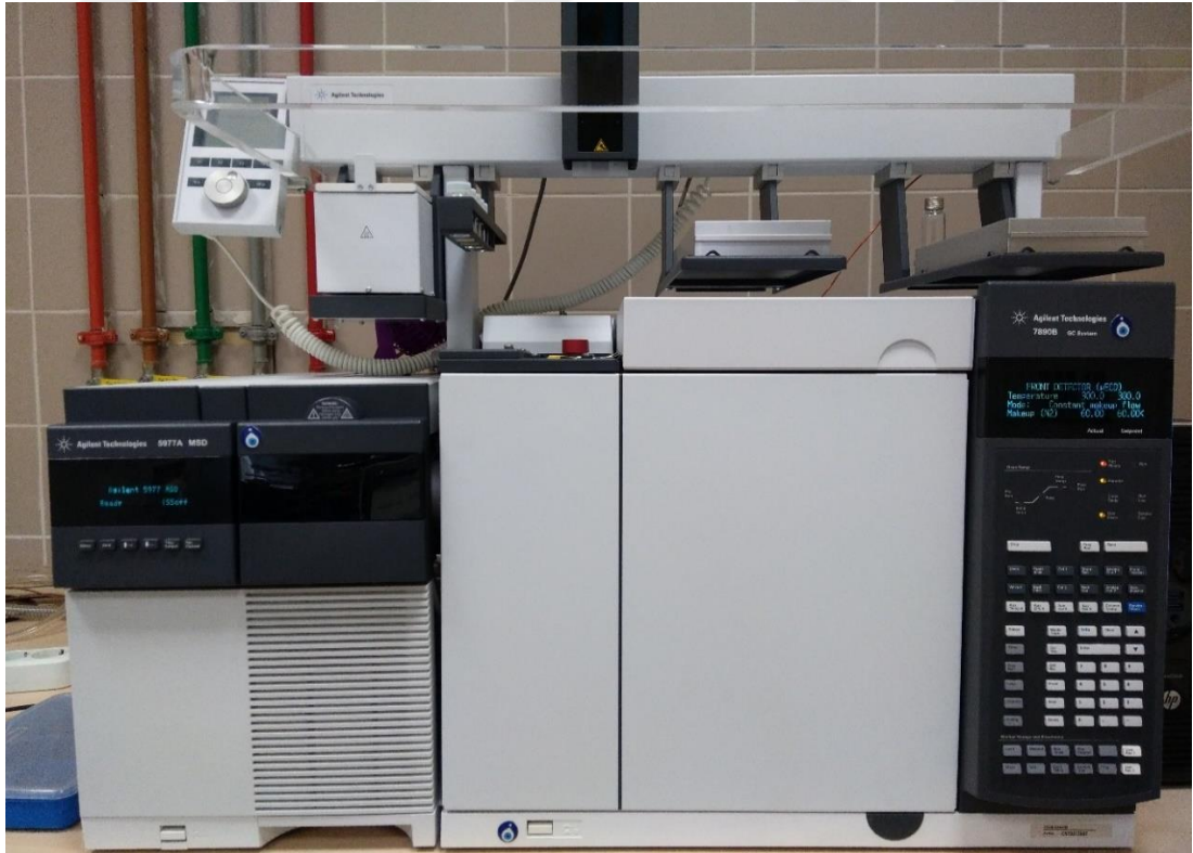
řekil 2.6. Analizlerde kullanılan Agilent 6890N GC ve 5973 Inert MSD GC-MS
