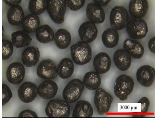
Şekil 4.3. S60 paslanmaz çelik bilya optik mikroskop fotoğrafı (1X büyütme)
