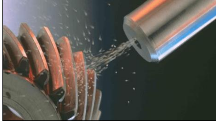
Şekil 2.2. Bilyalı dövme işlemi [24]
