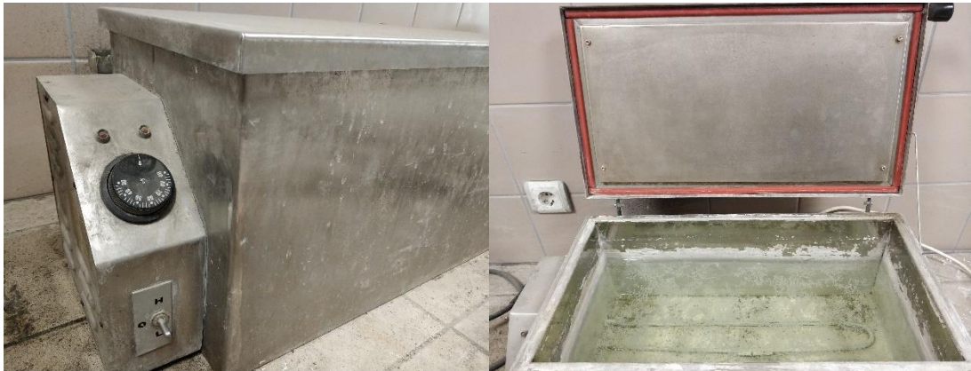
Şekil 3.6. Isı ayarlı kür havuzu
