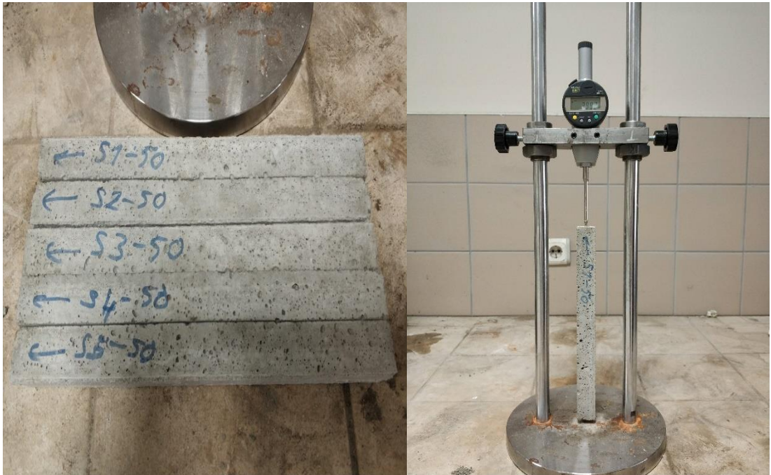
Şekil 3.12. 25x25x285 mm boyutundaki numuneler ve rötire ölçüm aleti
