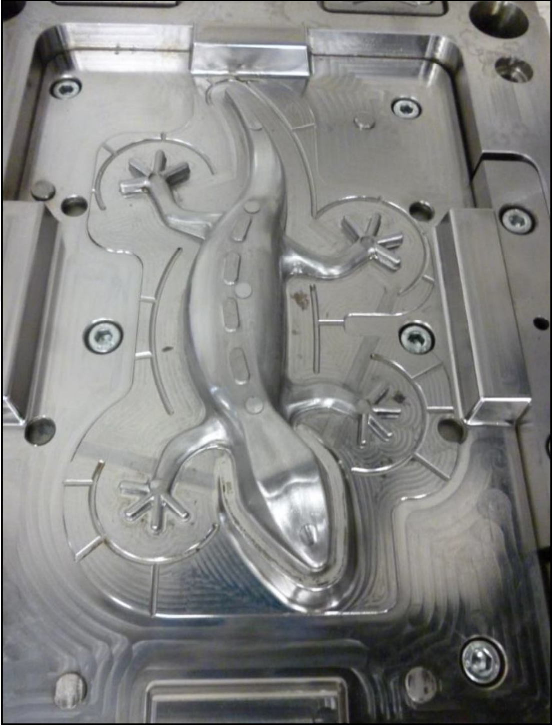
Şekil 3.8. Gekko kalıbı itici tarafı görseli
