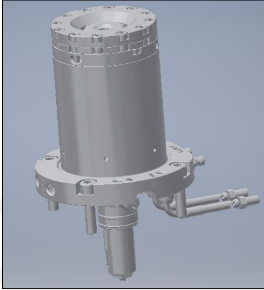
Şekil 3.9. Gekko kalıbı sıcak yolluk sistemi görseli
