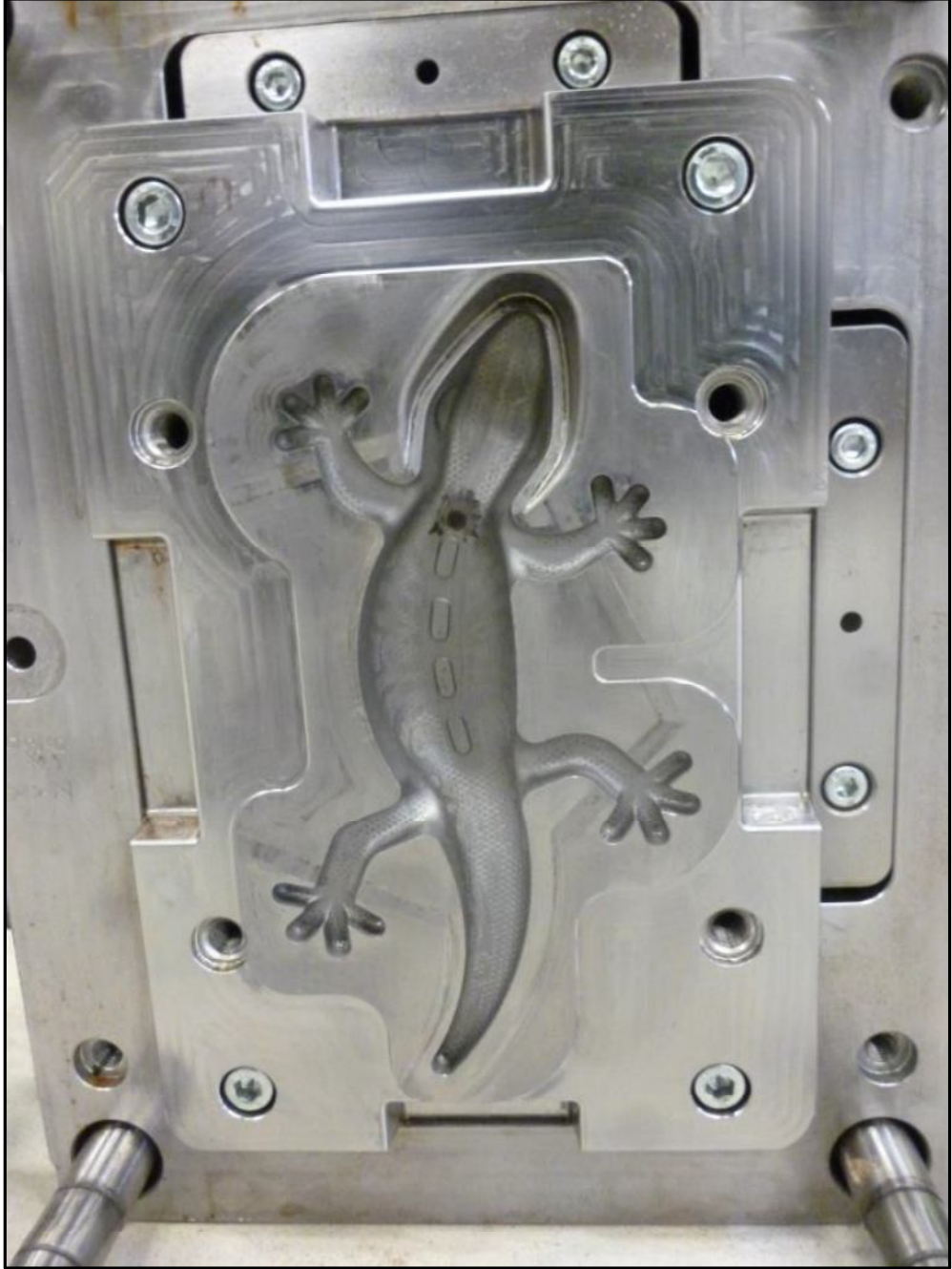
Şekil 3.5. Gekko kalıbı enjeksiyon tarafı g
