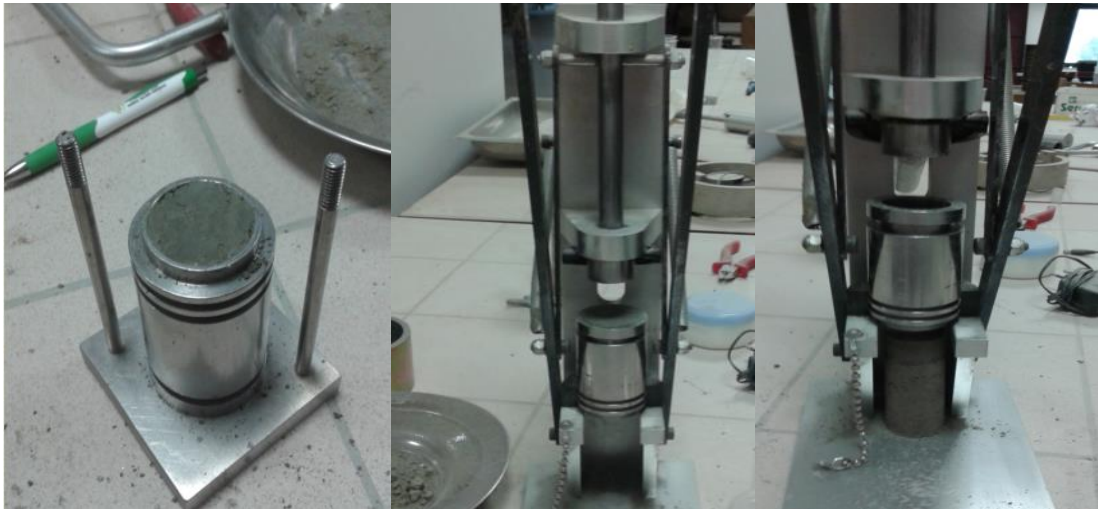
Şekil 4.8. Minyatür proktor aleti ile numune hazırlanışı
