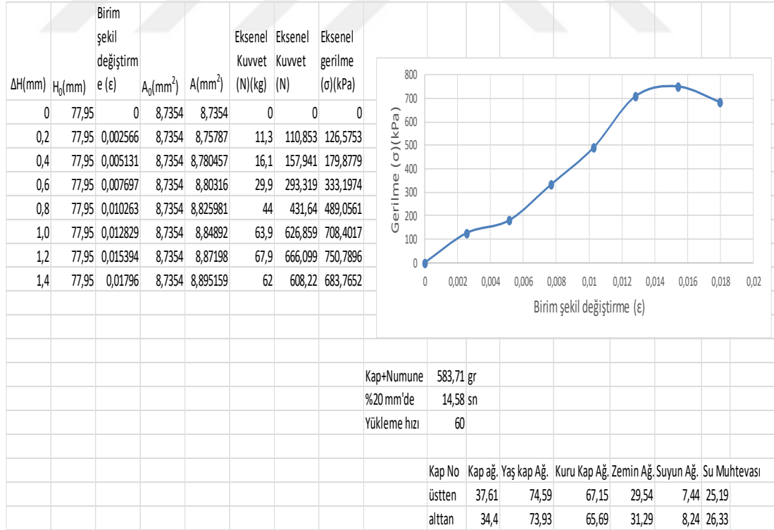
Şekil B.64. Doğal su muhtevasında %10 çimentolu zeminin 7 günlük serbest basınç deneyi-2
