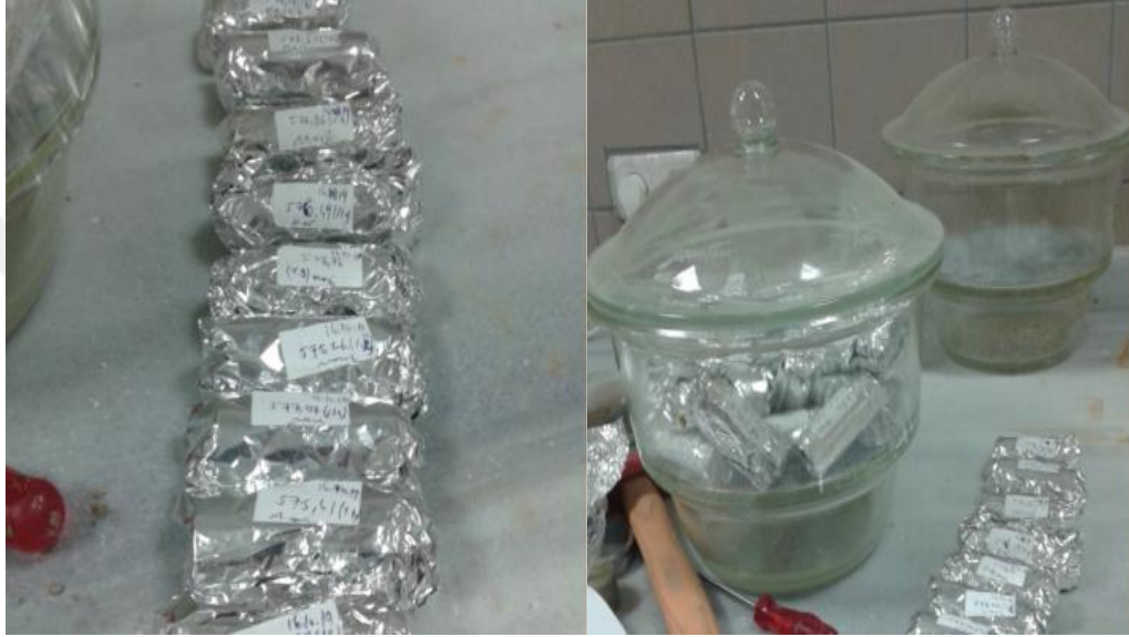
řekil 4.13. Numunelerin alminyum folyoyla sarılması
