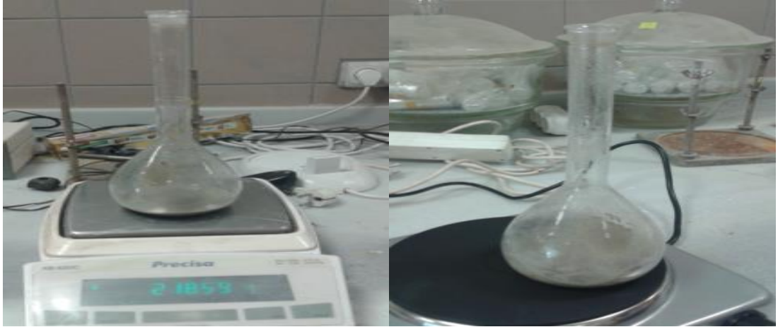
Şekil 4.1. Piknometre deneyi için numune hazırlanışı
