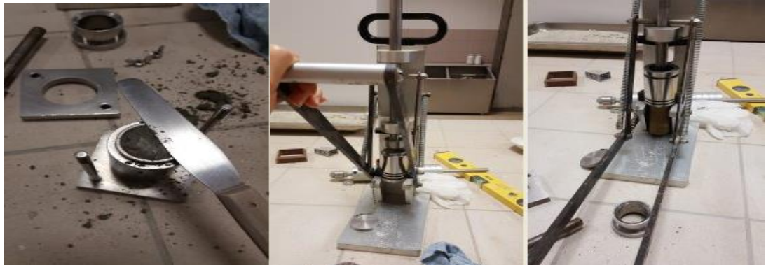
Şekil 3.10. Minyatür proktor aleti ile numune hazırlanışı
