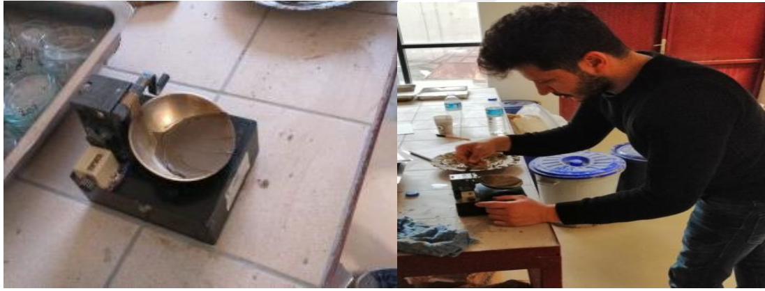
Şekil 3.2. Likit limit deneyinin yapılışı
