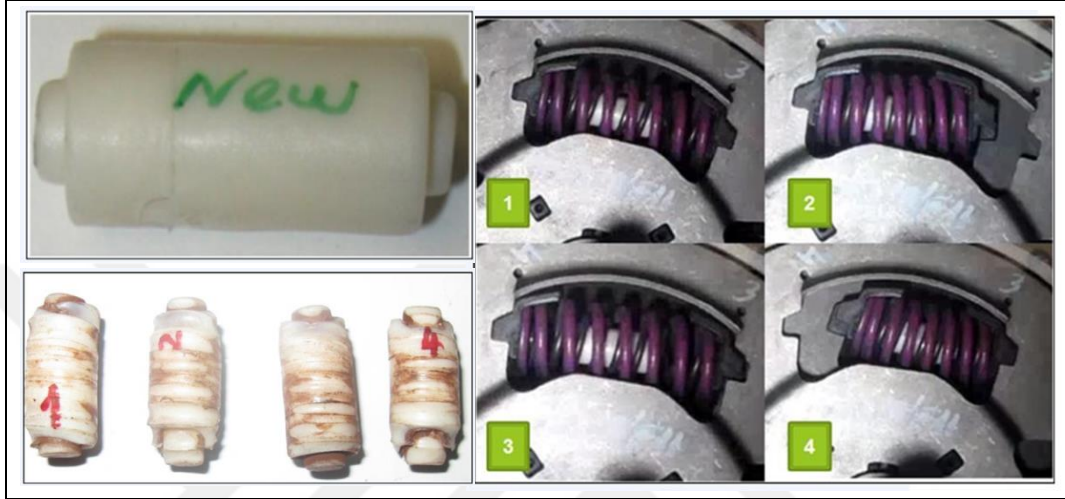
Şekil 1.2. Tork limitleyici sistem içerisinde kullanılan TPE ve aşınma yüzeyine ait firmadan gelen bir görsel
