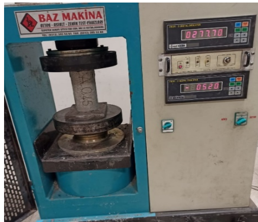
Şekil 3.28.Basınç dayanım deneyi
