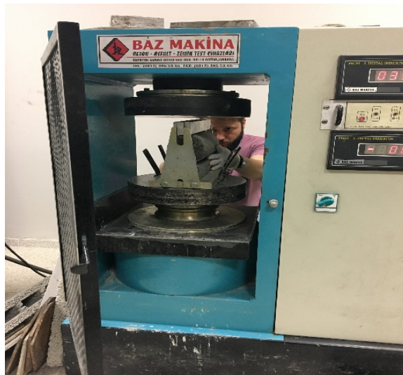
Şekil 3.30.Yarmada çekme dayanım deneyi
