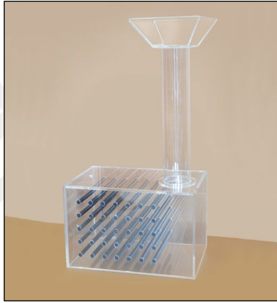
Şekil 1.6.Doldurma kutusu deney aparatı
