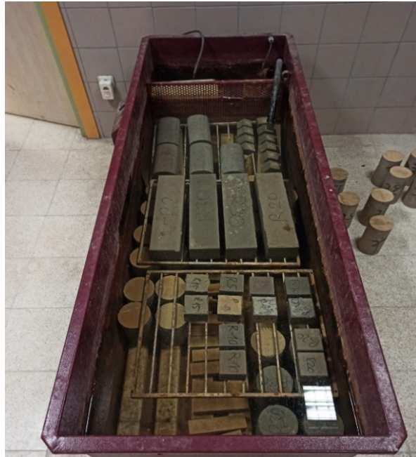
Şekil 3.25..Kür havuzlarında bekletilen numuneler
