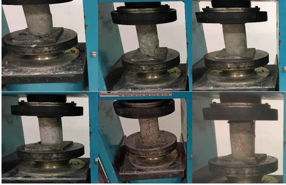
Şekil 4.1.Sırasıyla numunelerin basınç dayanımı deneyi kırılma şekilleri
