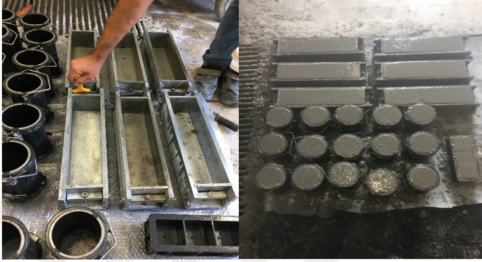
Şekil 3.24. Yağlanarak hazırlanan kalıplar ve kalıplara dökülen numuneler
