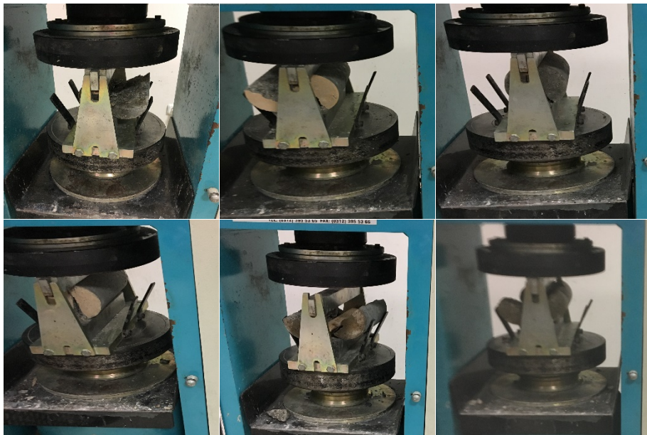
Şekil 4.4.Sırasıyla numunelerin yarmada çekme deneyi kırılma şekilleri
