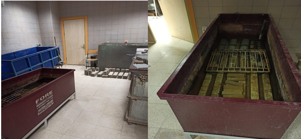
Şekil 3.17.Kür odası ve kür havuzları
