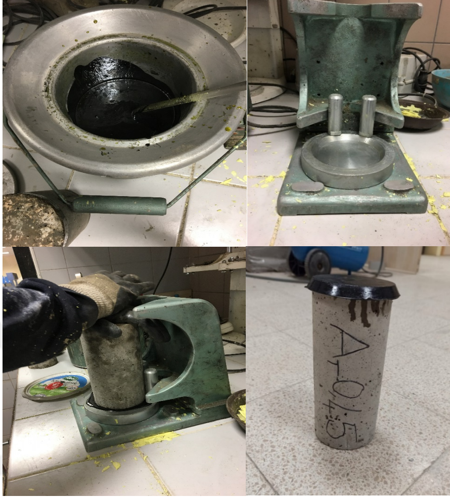
Şekil 3.27.Silindir numunelere kükürt başlık yapma işlemi
