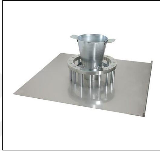
Şekil 1.12.J ring deney aparatı
