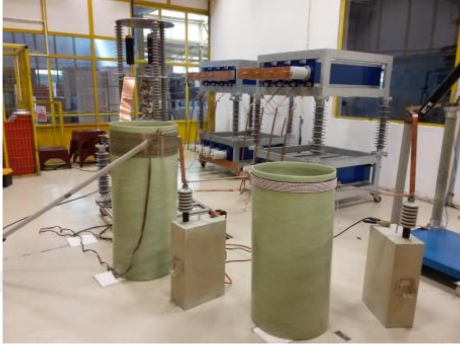
Şekil 5.23. 30/80 \mu s akım darbesi için oluşturulan set
