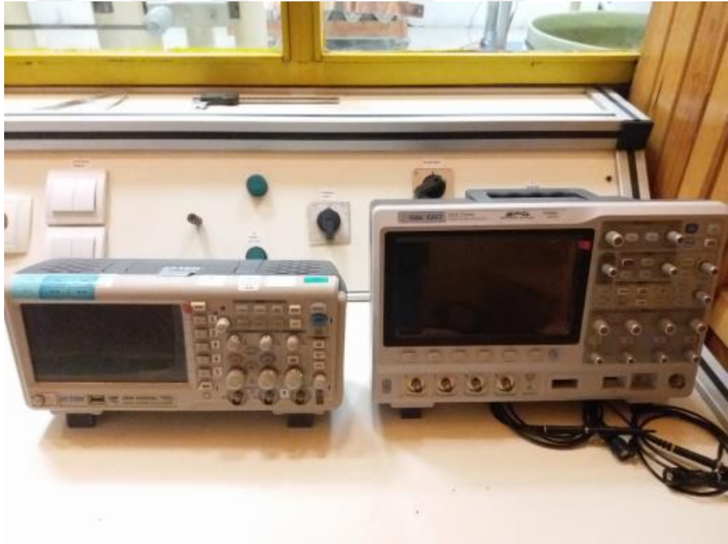
Şekil 5.5. Ölçümlerin yapıldığı osiloskoplar (Sol: Atten marka 2 kanallı 200 MHz kalibrasyonlu osiloskop, Sağ: Siglent marka 4 kanallı 300 MHz osiloskop)
