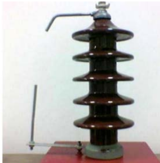
Şekil 1.5. 36 kV'luk transformator tipi geçit izolatörü ve koruma elektrodu
