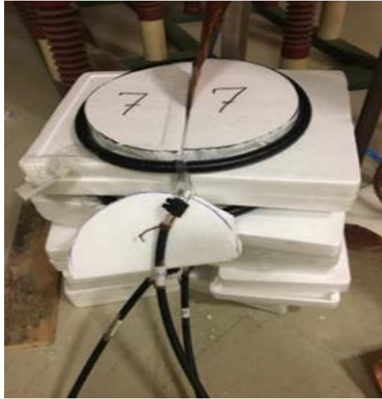
Şekil 5.24. Rogowski akım sensörlerinin akım taşıyan bara etrafına konumlandırılması
