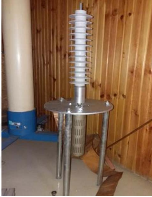
Şekil 5.3. Deney numunesi (Parafudr) ve kalibrasyonlu akım ölçüm şöntü (ELOPAR 36/10 kV/kA, HILOTEST I_{pmax}=20 kA)
