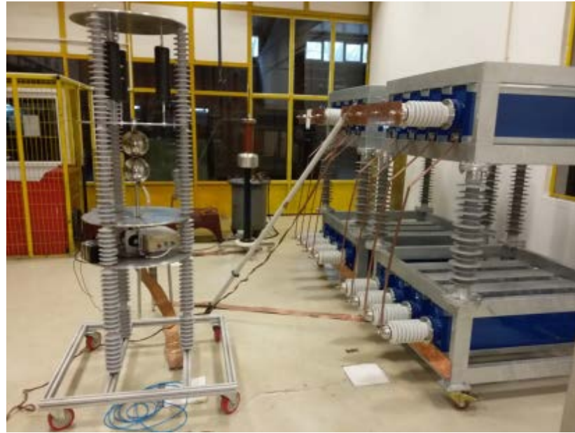
Şekil 5.22. 4/10 \mu s ve 8/20 \mu s darbe akımı seti olarak kullanılabilcek üreteç seti
