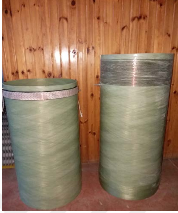
Şekil 5.19. 30/80 \mu s darbe akımı için üretilen bobinler (Sol: L_1=50 \mu H Sağ: L_1=400\mu H)
