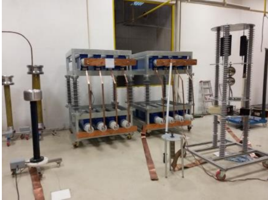
Şekil 3.3. Tasarımı gerçekleşen darbe akım üretici ve ölçüm seti
