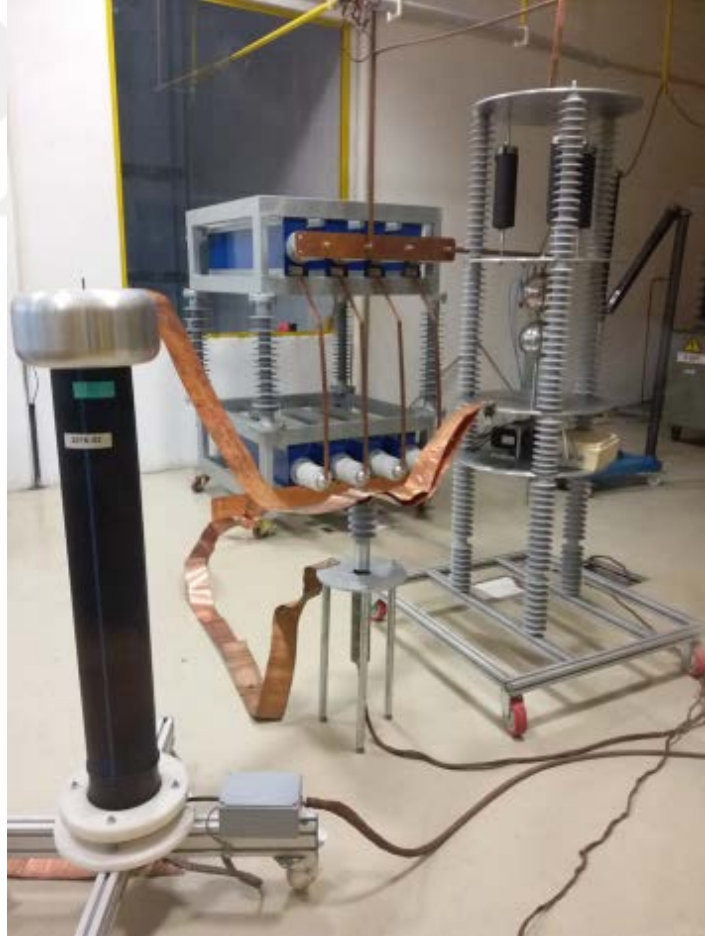
Şekil 6.4. 8/20 \mu s Yıldırım akım darbesi artık gerilim ölçümü deney devresi
