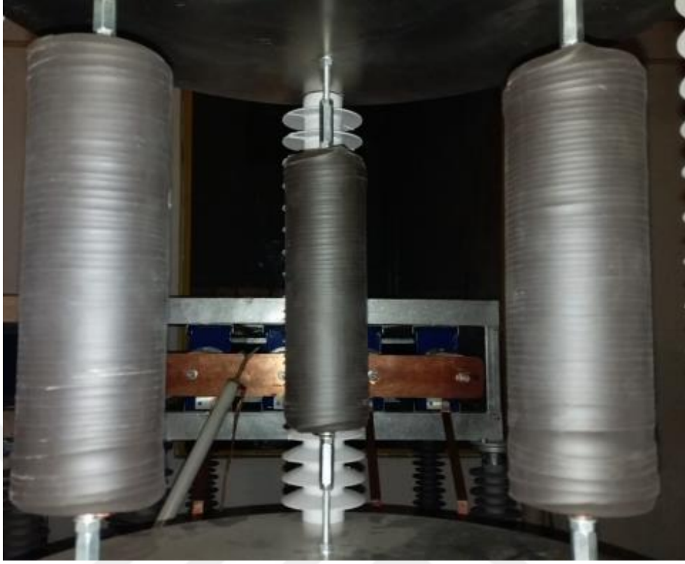
Şekil 5.16. 8/20 \mu s'lik darbe akımı için üretilen bobinler (her biri \sim 60 \mu H)
