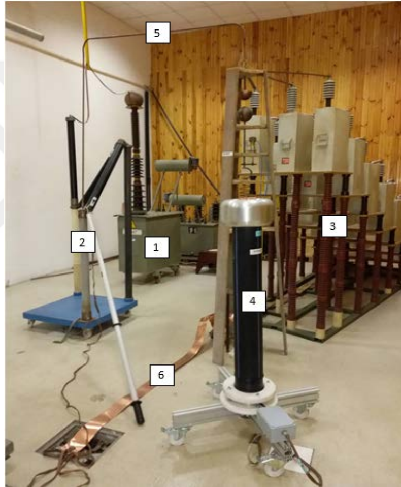
Şekil 5.1. Yıldırım darbe akımı artık gerilim ölçüm seti (8/20 \mu s). 1: Yüksek gerilim besleme trafosu, 2: Doğrultma katı, 3: Kondansatör grubu, 4: Gerilim bölücü, 5: Ara bağlantı, 6: Topraklama şeridi
