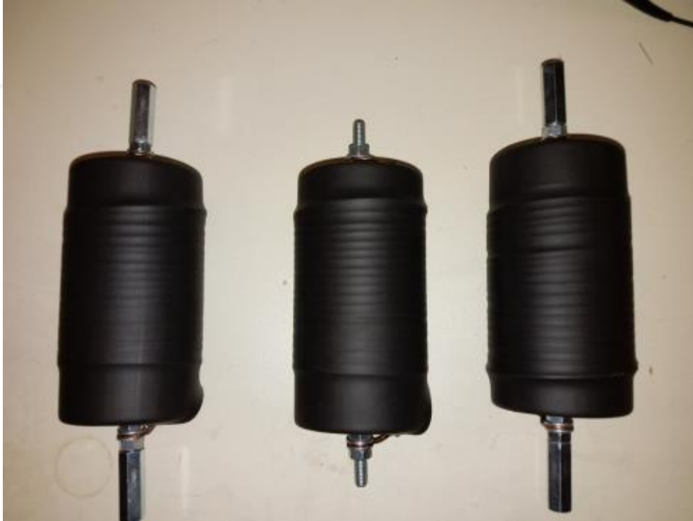
Şekil 5.12. 4/10 \mu s'lik darbe akımı için üretilen bobinler (her biri \sim 12 \mu H).
