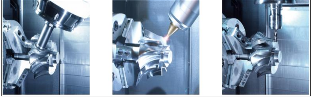
Şekil 1.13. Mazak hibrit çoklu-görev makinesi [19]
