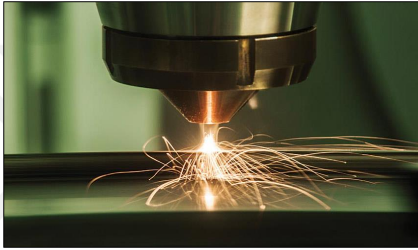
Şekil 1.14. Beam DED Makinesi lazerli Üretim kafası [20]
