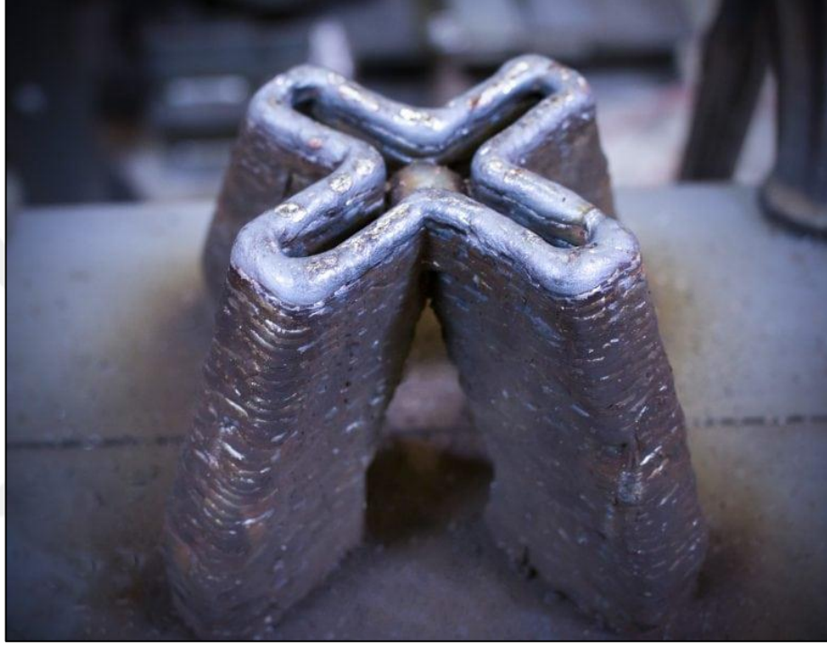
Şekil 1.25. Katmanlı imalatla üretilen yüzey kalitesi düşük bir parça [32]
