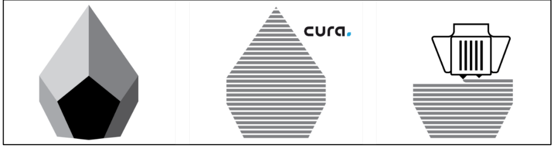
Şekil 1.29. CAD, Dilimleme ve 3 boyutlu üretim
