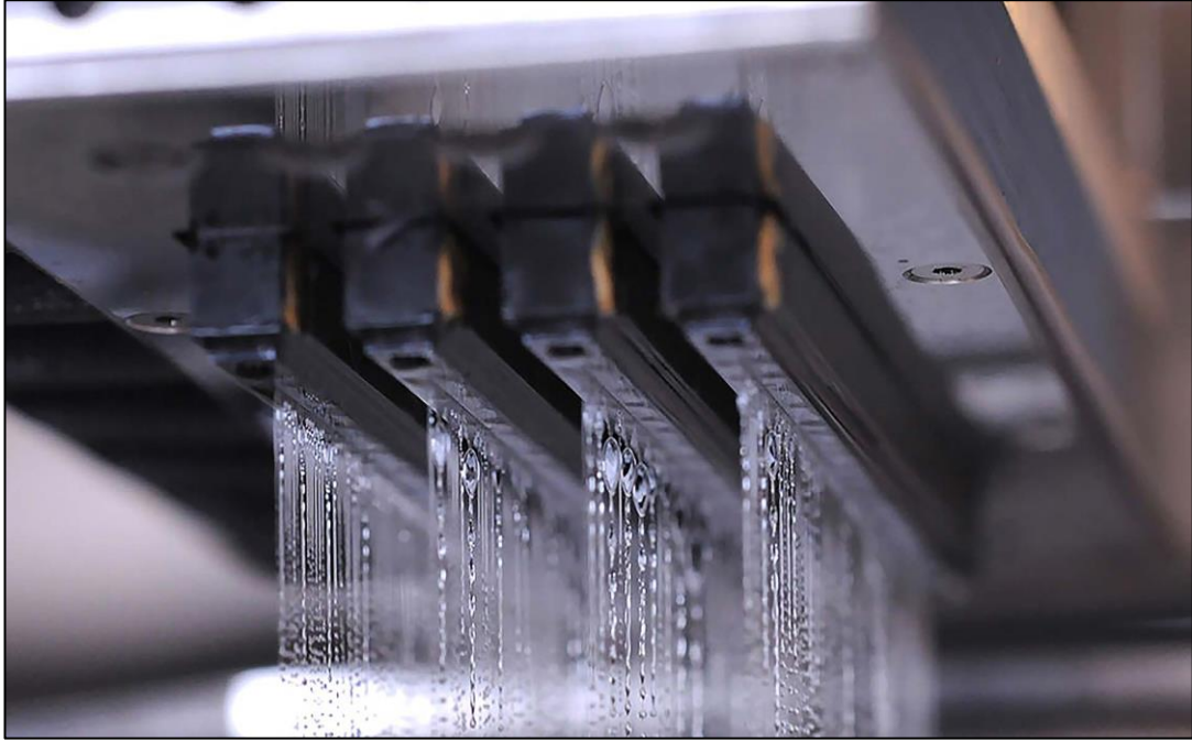
Şekil 1.10. ExOne firmasının yapıştırıcı püskürtme makinesi [17]
