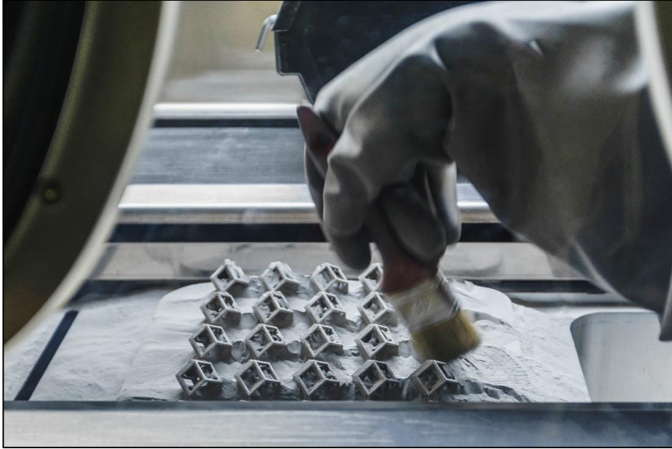
Şekil 1.34. PBF teknolojisiyle üretilen parçaların kalıntı tozlarından temizlenmesi [16]
