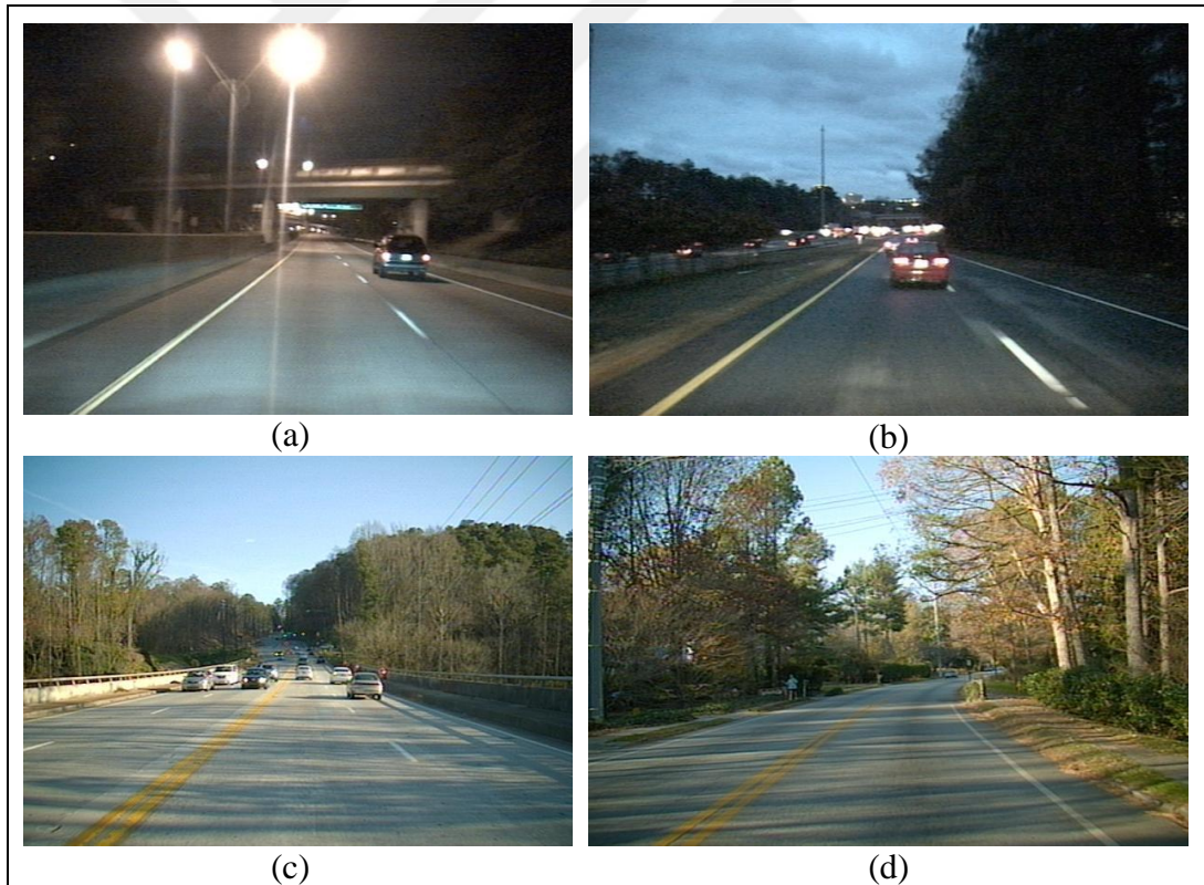
Şekil 2.2. Araçlar seyir halinde iken kamera ile alınan bozucu etkilere sahip görüntüler (a) ve (b) Karanlıkta ışık patlaması (c) ve (d) Gölge ve bozucu etkenler
