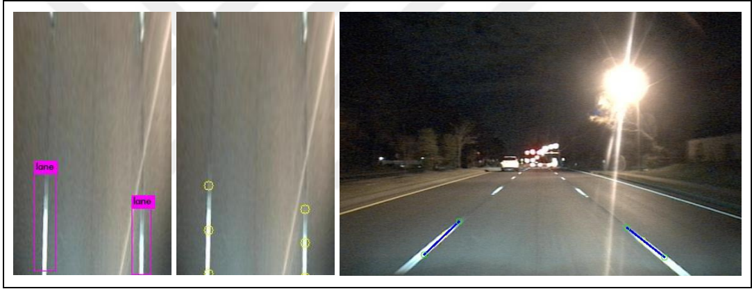
Şekil 4.21. Geliştirilen yöntemin deneysel sonuçlara hazırlanması (a) YOLO tespit sonucu (b) Tespit sonuçlarından alınan örnek noktalar (c) PM dönüşümü sonrası elde edilen doğrular
