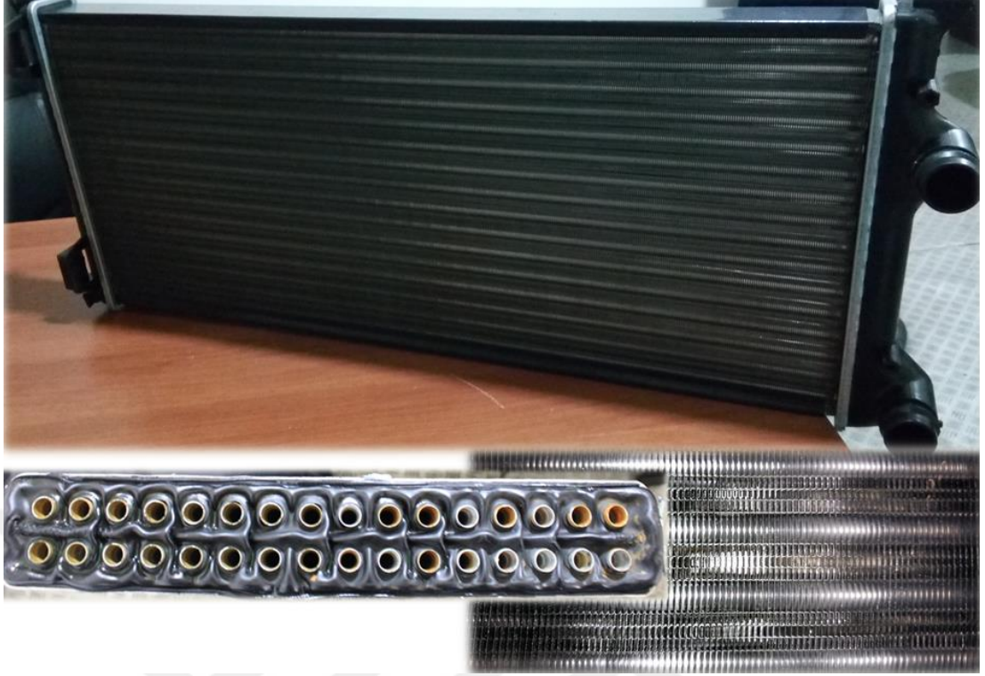
Şekil 2.21. Deneysel sistemde kullanılan dairesel tüplü radyatör
