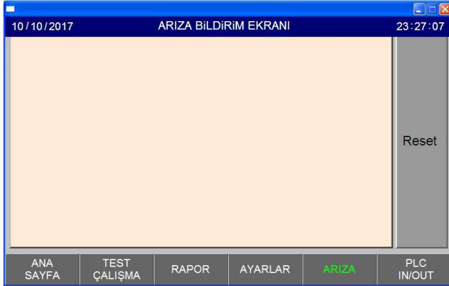
Şekil 2.19. Test sistemi işletim programı arıza bildirim sayfası
