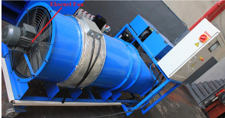
Şekil 2.4. Sürüş hızını simüle eden eksenel fan genel görünüşü
