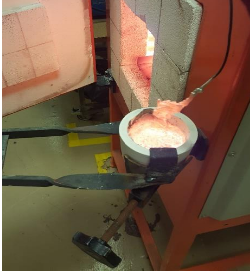
Adım-3: Homojen karışımın sağlanması için eriyik kompozitin karıştırılması
