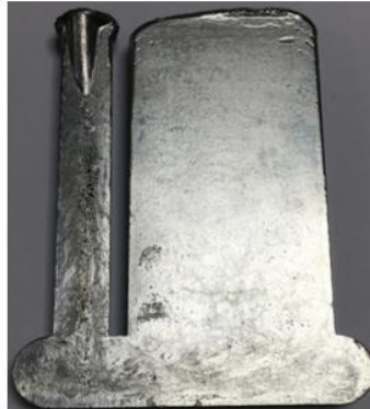
(b) 800 °C, 20 dak, %1 SB katkılı kompozit malzeme arka yüzeyi
