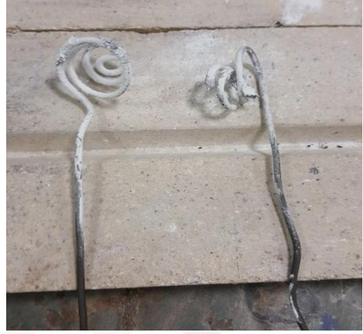
Adım -2: Homojen karışım sağlanması ve yüzeyde oluşan cürufun alınması için karıştırıcı çubukların hazırlanması
