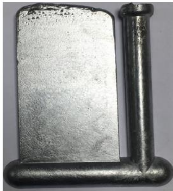
(a) 800 °C, 20 dak, %1 SB katkılı kompozit malzeme ön yüzeyi
