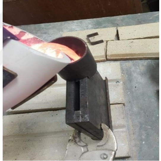
Adım-4: Eriyik kompozitin kalıba dökülmesi
