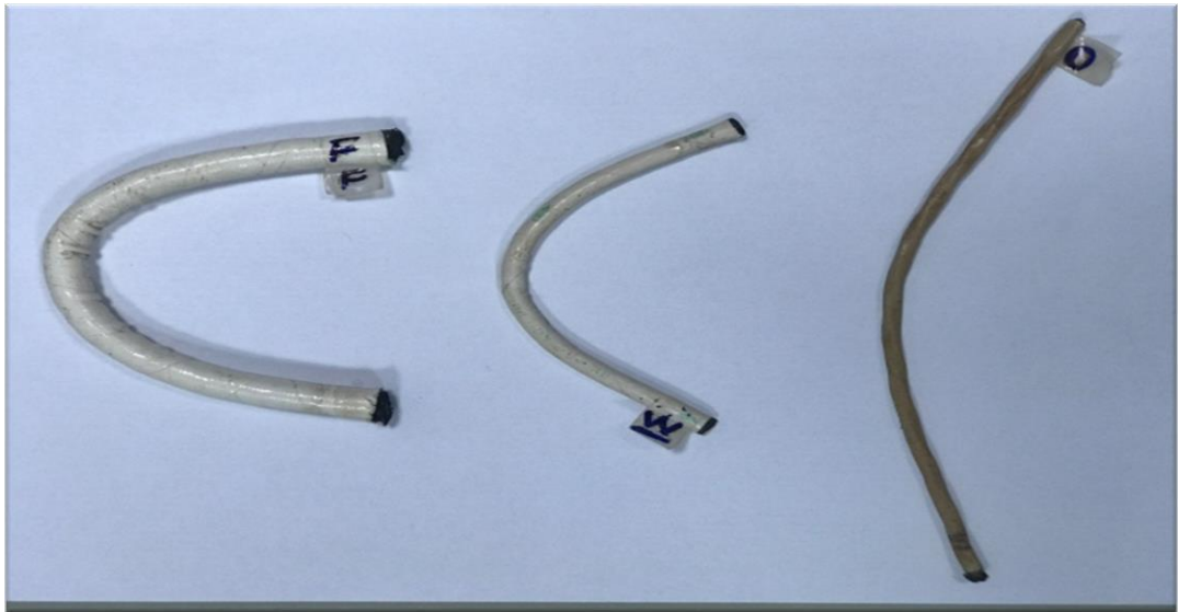
Şekil 3.12. Jet yakıtına maruz kalan kablo grubu (FOW)
