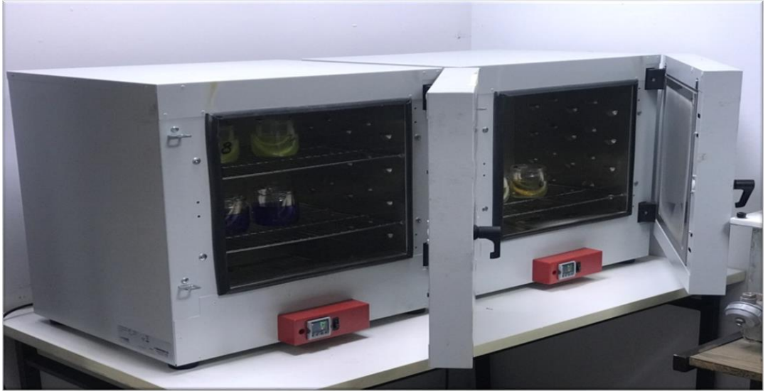
Şekil 2.20. Deneyde kullanılan yaşlandırma fırınları
