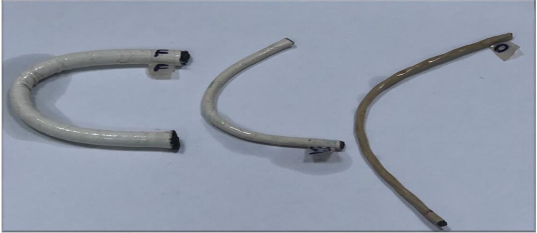
Şekil 3.9. De-icing sıvısına maruz kalan kablo grubu (FOW)
