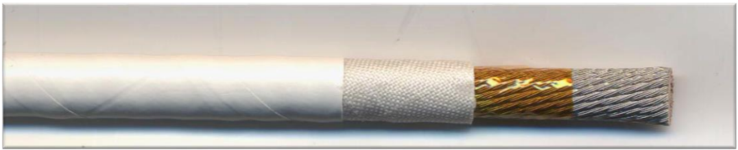
Şekil 1.7. Bir güç kablosu örneđi (Ayrıca bu kablo testlerde kullanılan kablolardan birisidir.) [24]
