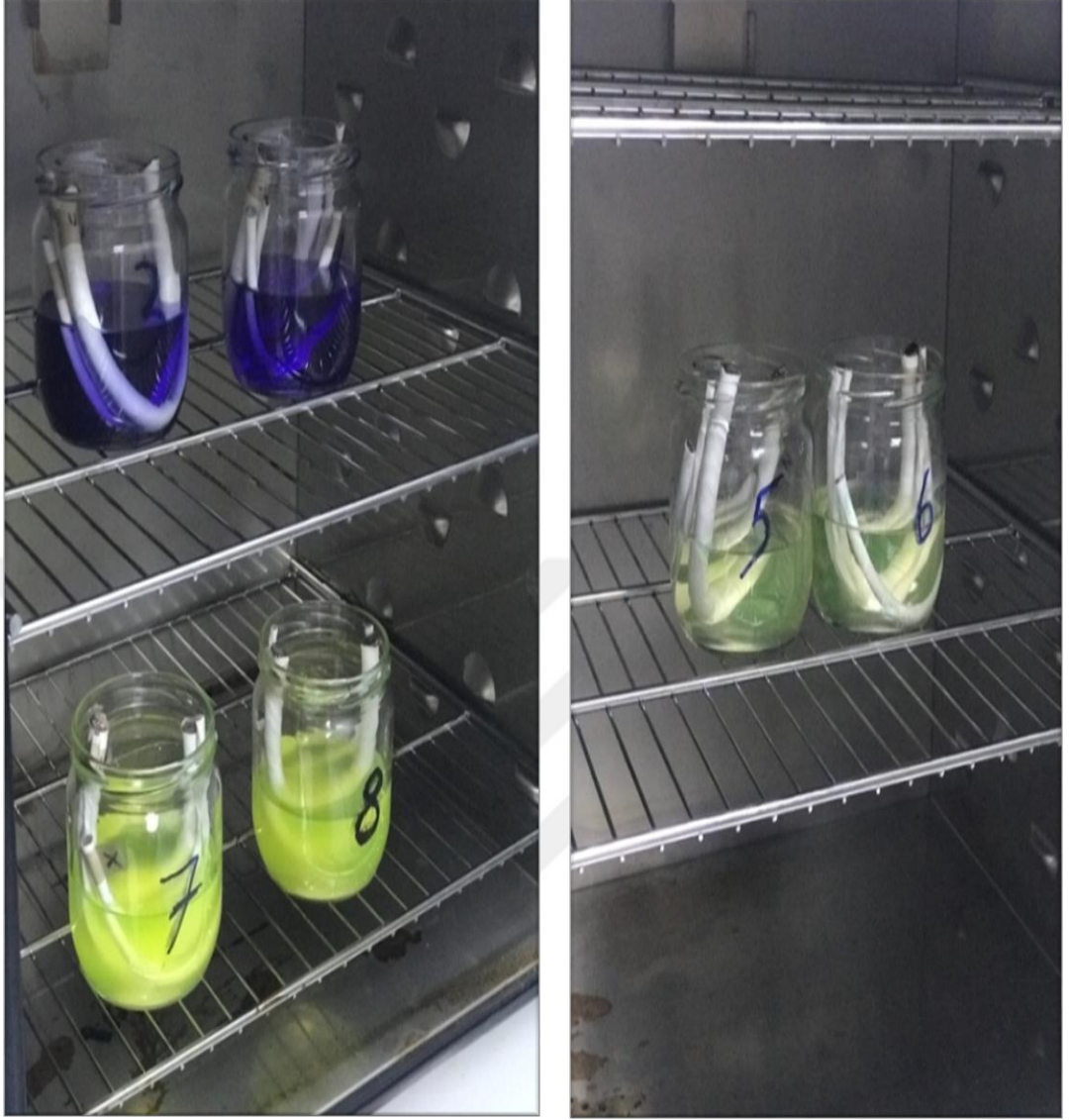
Şekil 3.1. Fırınlara 2 saatlik süreç için kimyasallarla birlikte konulan kablolar
