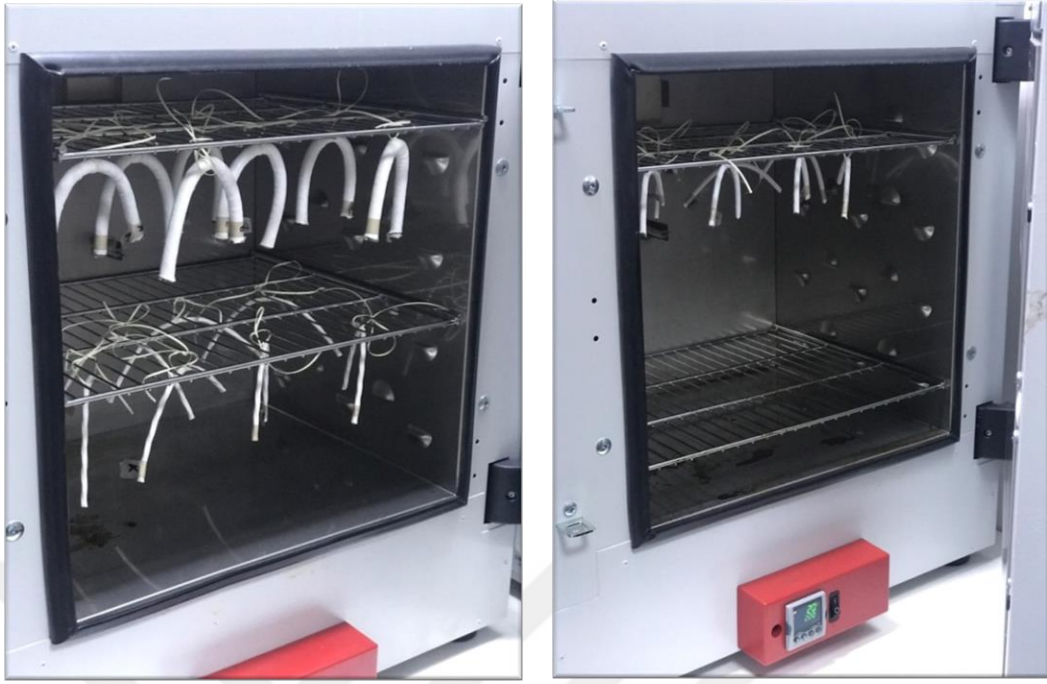
Şekil 3.2. Özdeş iki fırına bağlanılan kablo numuneleri
