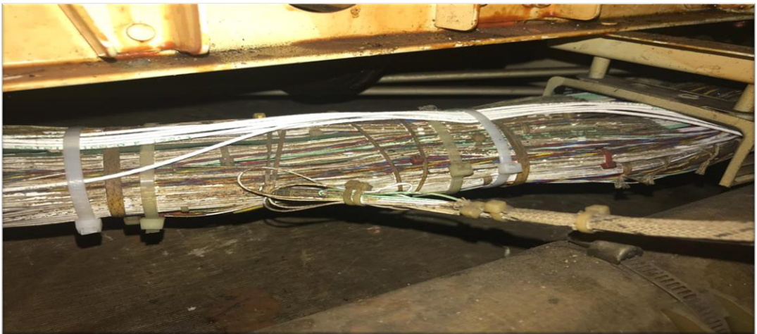
Şekil 1.10. Birçok yaşlanma etkeninin aynı anda bulunduğu kablo demeti
