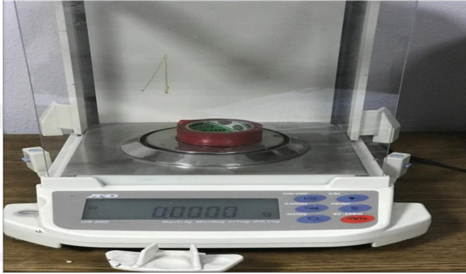
Şekil 2.16. Hassas ölçüm için kullanılan And Gr-200 cihazı
