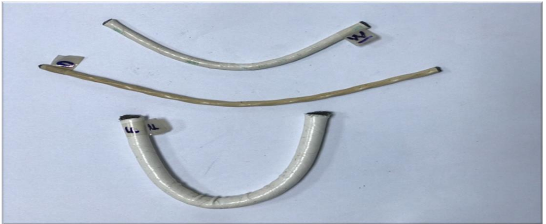
Şekil 3.5. Temizleme sıvısına maruz kalan kablo grubu (FOW)
