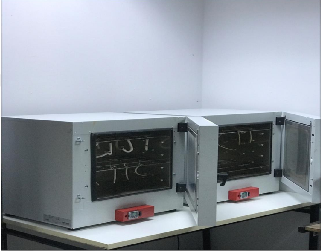
Şekil 3.6. 250-500 saat arası için fırına konulan kablo numuneleri
