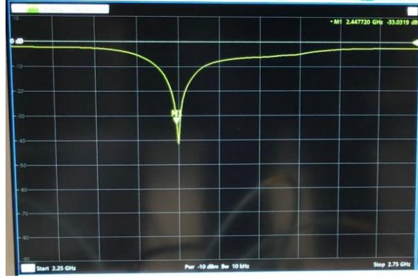
Şekil 4.5. Son tasarım anten laboratuvar ölçümü yansımaya katsayısı grafiği
