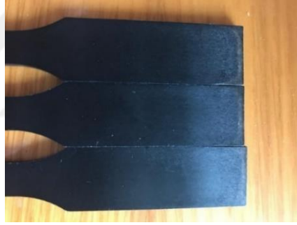
Şekil 3.153. %30 Cam elyaf takviyeli PA66 yanık izleri
