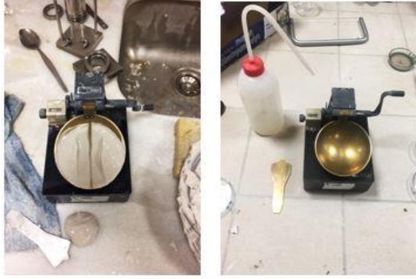
Őekil 3.6. Casagrande deney cihazı ve numune yerleŐtirilmesi
