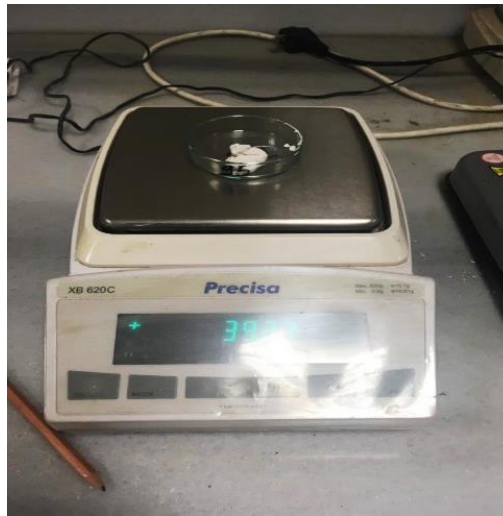
Őekil 3.8. Likit limit belirlenmesi iin yapılan tartım iŐlemi
