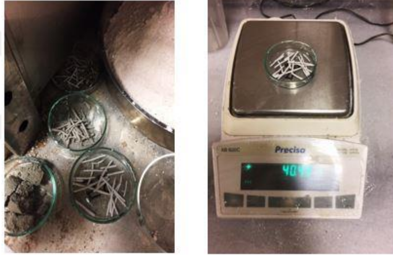
Şekil 3.9. Plastik limit deneyi ile su muhtevası bulunması
