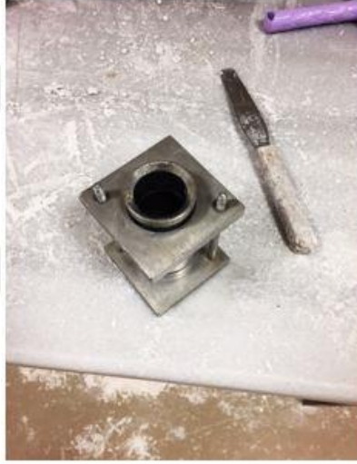
Şekil 3.10. Proktor kalıbı ve deney numunesi
