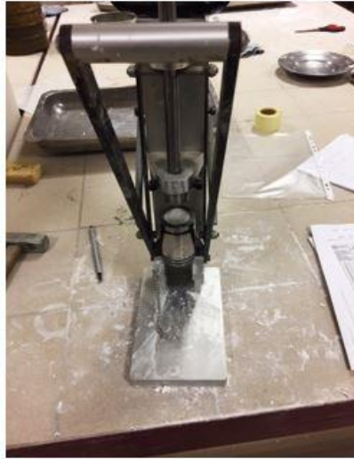
Şekil 3.11. Deney numunesinin sıkıştırılması
