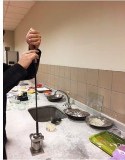
Şekil 3.11. Deney numunesinin sıkıştırılması
