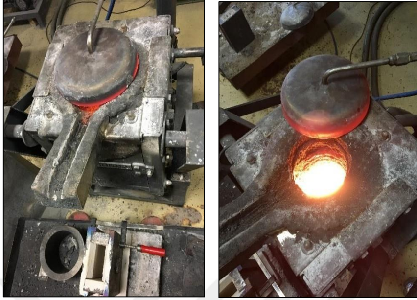
Şekil 2.4. Ar koruması altında ergitme ve döküm işlemi
