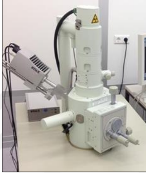
Şekil 2.12. JEOL JSM-6060 SEM
