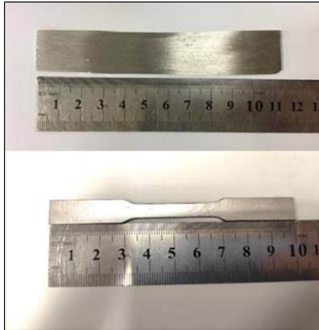
Şekil 2.14 ASTM E8'e göre hazırlanan sub-size çekme test numunesi
