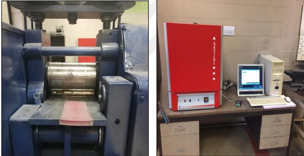
Şekil 2.5 Haddeme düzeneği ve ısıtma işlem fırını
