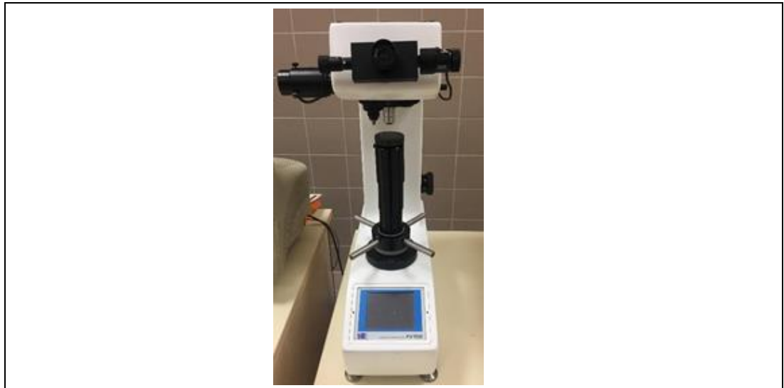
Şekil 2.11. Future-Tech FV-700 Vickers sertlik cihazı
