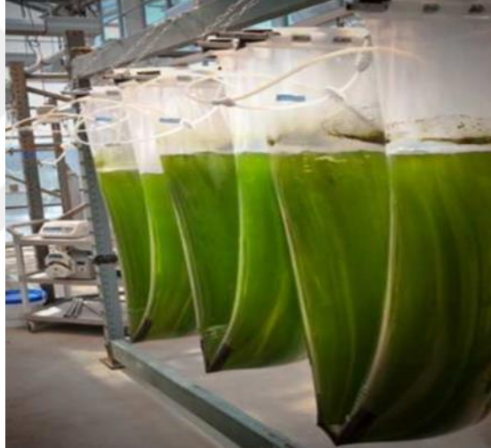
Şekil 4.5. Plastik torbalarda üretim [50]
