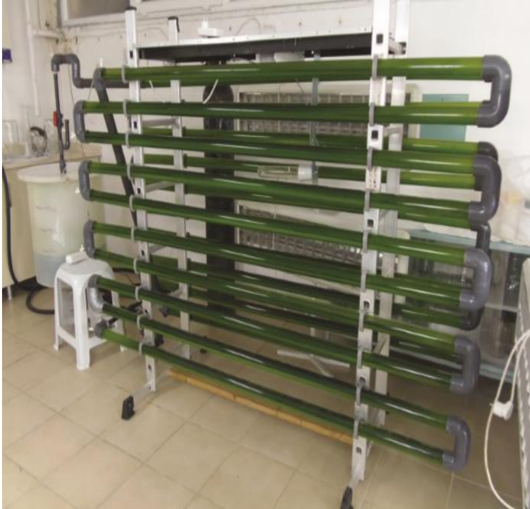
Şekil 4.7. Tübüler fotobiyoreaktörün genel görünümü [54]
