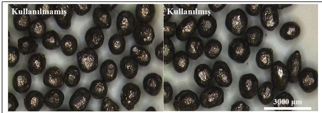
Şekil 5.15. S60 cam kürelerin bilyalı dövme öncesi ve sonrası stereo mikroskop görüntüleri (1x büyütme), a) dövme öncesi (kullanılmamış), b) dövme sonrası (dövme işlemlerinde kullanılmış)
