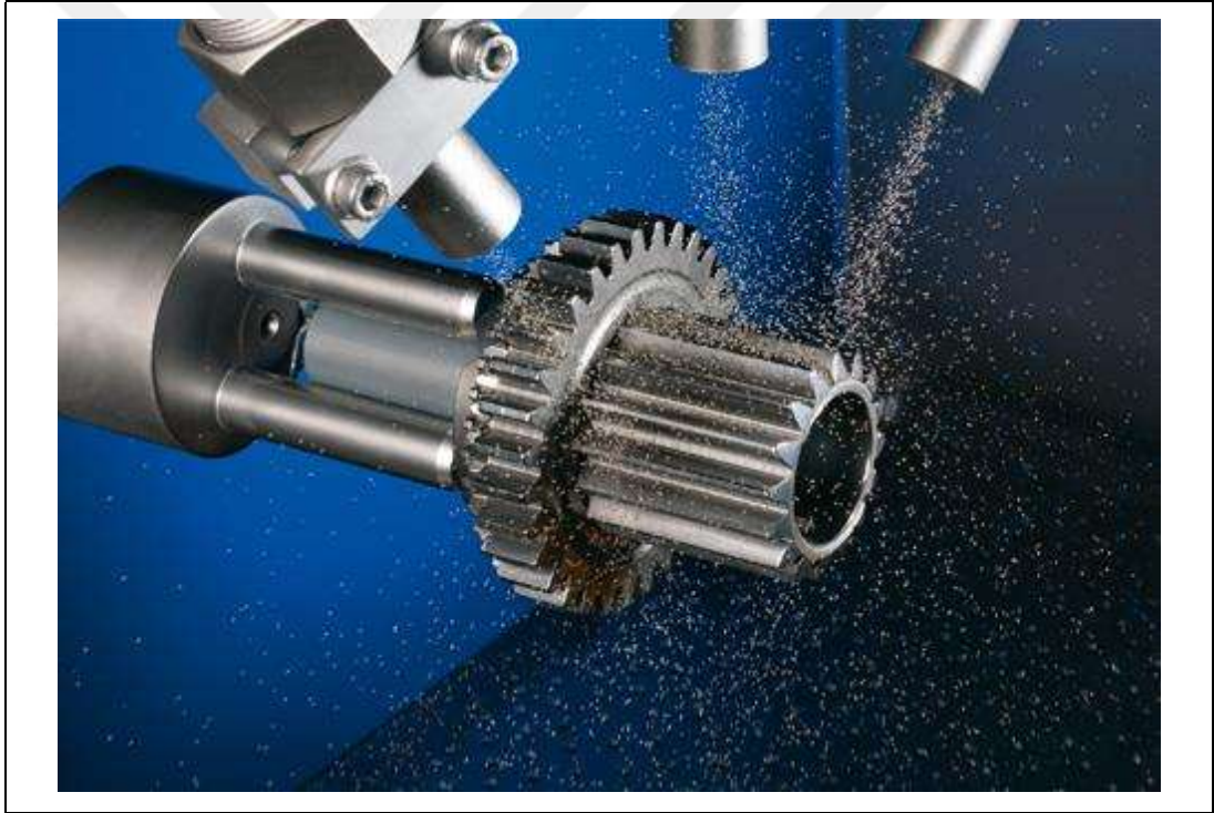
Şekil 2.1. Bir dişli parçasına uygulanan bilyalı dövme uygulaması [31]
