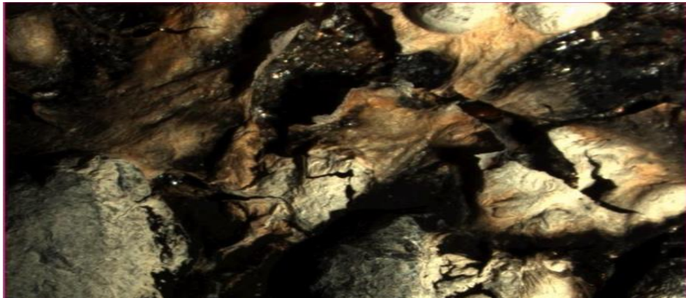
Şekil 4.17. T5 Kaplamasının Yanma Sonrası Optik Mikroskop Görünümü
