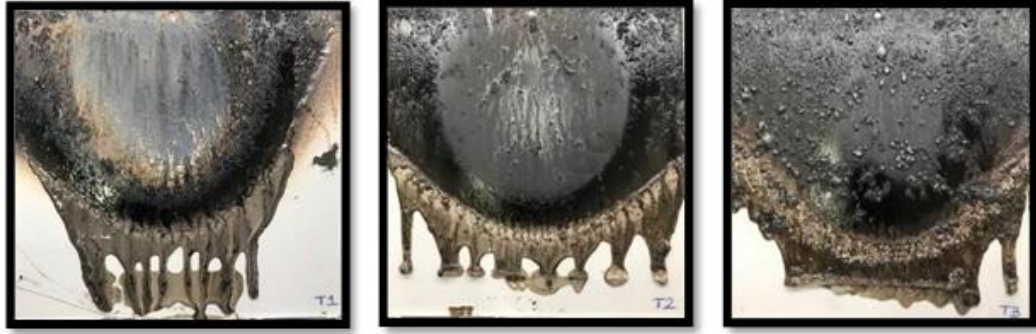
Şekil 4.7. Amonyum Polifosfat Katkılı T1, T2, T3 Kaplamalarının Alev Testi Sonrası Görünümleri
