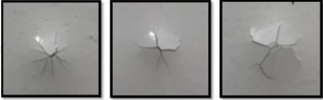
Şekil 4.21. ÇB Katkılı T7, T8, T9 Kaplamalarının 25kg.cm Değerinde Darbe Testi Sonuçları
