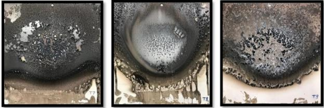
Şekil 4.11.Çinko Borat Katkılı Kaplamaların T7, T8, T9 Alev Testi Sonrası Görünümleri
