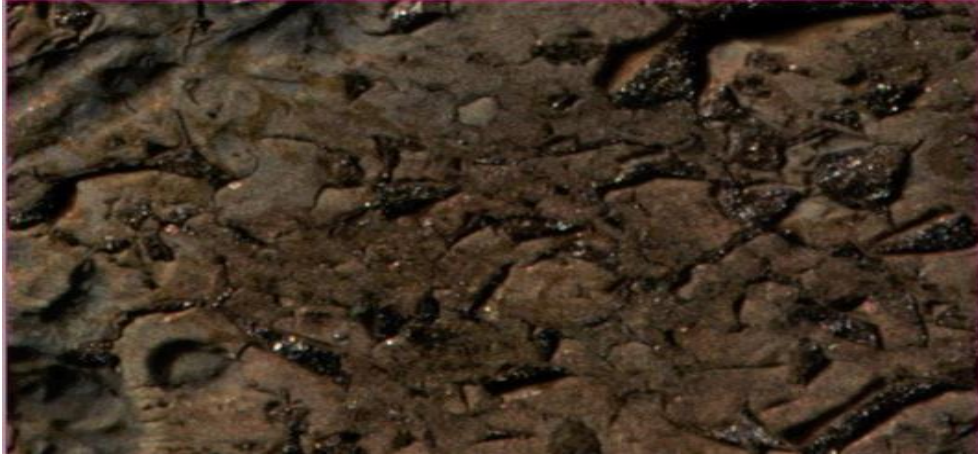
Şekil 4.15. T0 Kaplamanasının Yanma Sonrası Optik Mikroskop Görünümü
