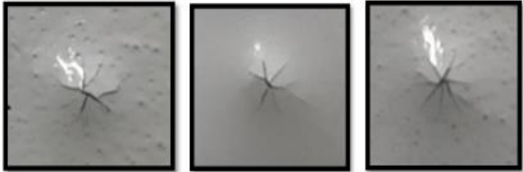
Şekil 4.22. Karışık Alev Geciktiricili T10, T11, T12 Kaplamalarının 25kg.cm Değerindeki Darbe Testi Sonuçları
