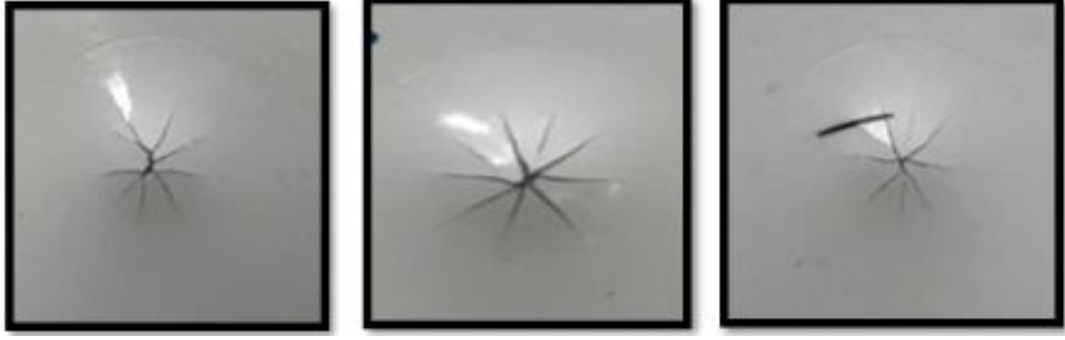
Şekil 4.19. APP Katkılı T1, T2, T3 Kaplamalarının 25kg.cm Değerinde Darbe Testi Sonuçları
