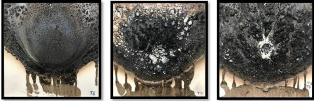
Şekil 4.9. Alüminyum Dietil-fosfinat Katkıli T4, T5, T6 Kaplamaların Alev Testi Sonrası Görünüşleri
