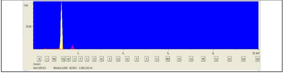
Şekil 6.25. %30 SiC takviyeli magnezyum matrisli kompozitin 1500x büyütmedeki SEM-EDX analiz sonucu
