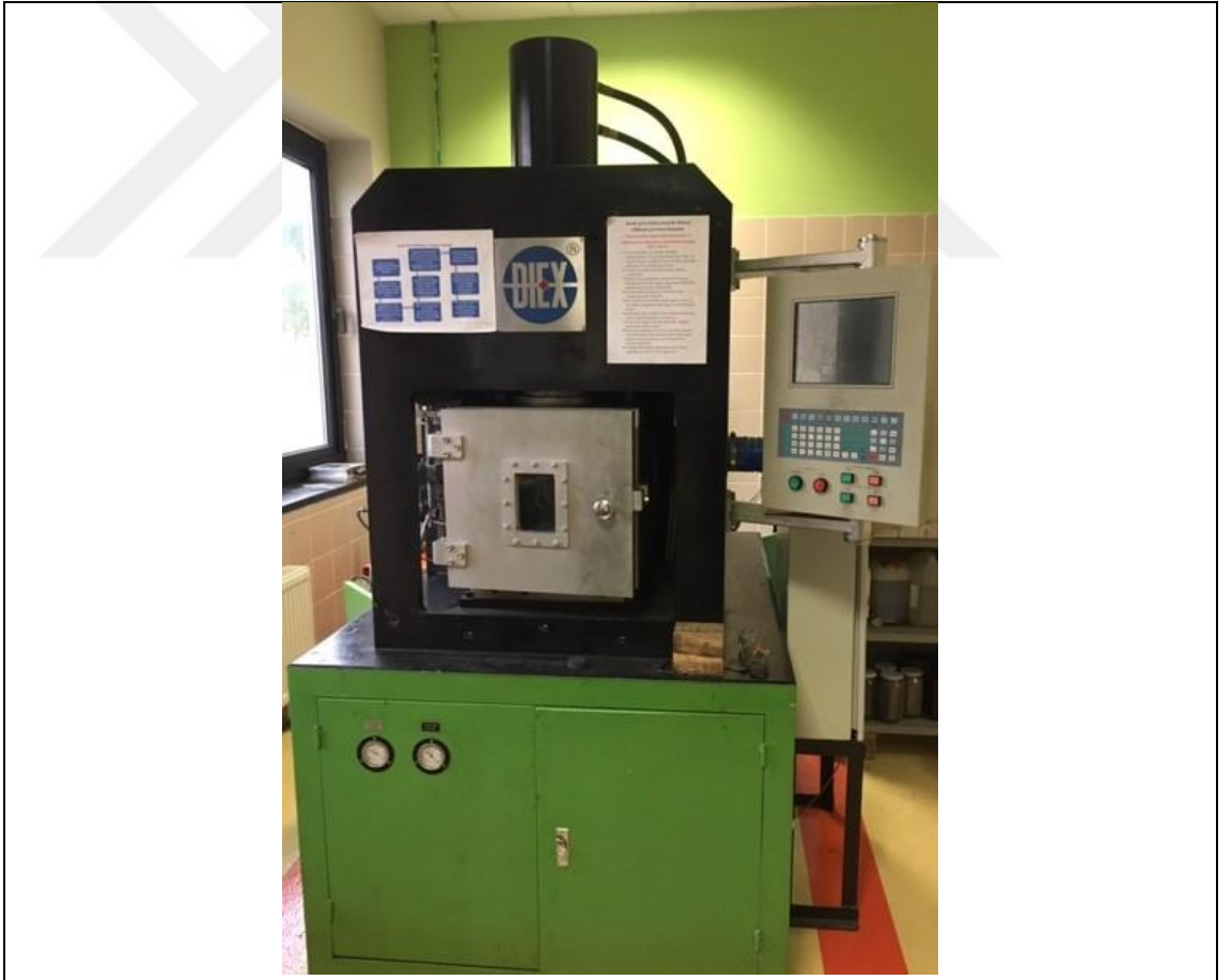
Şekil 5.3. Deneysel çalışmada kullanılan sıcak pres
