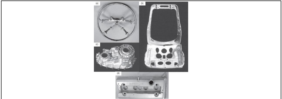
Şekil 3.1. Magnezyum otomotiv bileşenleri a) 0,75 kg ağırlığındaki Toyota için direksiyon göbeği b) 2,6 kg ağırlığındaki Jaguar ve Fiat için koltuk desteği c) AZ91D'den 2,7 kg ağırlığındaki aktarma elemanı ve d) AZ91 Ford motor için 0,9 kg ağırlığında kam kapak [24]
