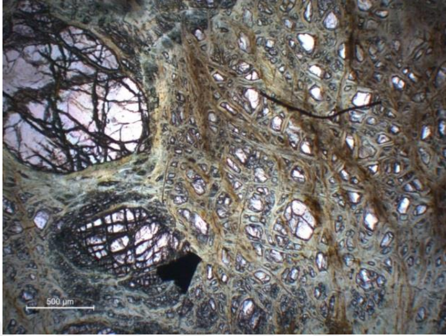
Şekil 3. 17. Mersin harzburgitine ait numunelerde bulunan olivin, ortopiroksen ve spinel mineralleri (tek nikol)
