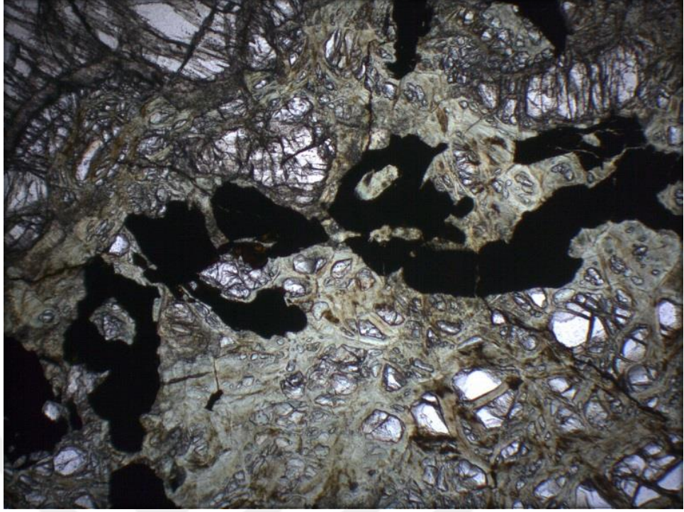
Şekil 3. 7. Kızıldağ harzburgitine ait numunelerde bulunan bazı spinel kristallerinde deformasyon sonucu oluşan uzama (tek nikol)
