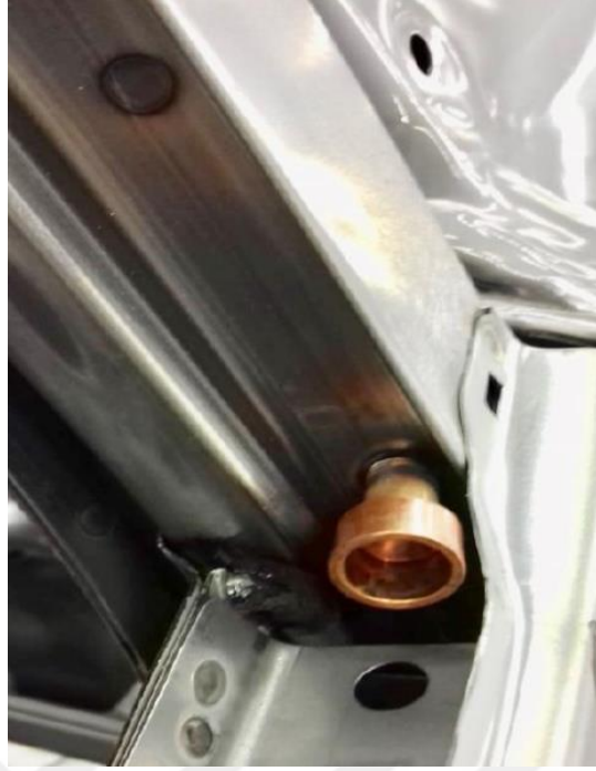
Şekil 4.23. Uç yapışmasına bir örnek
