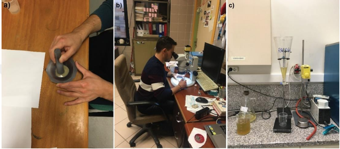
Şekil 1.6. (a) Mika minerallerinin aseton eklenecek şekilde öğütme işlemi, (b) ayıklanan minerallerin binoküler mikroskopta saflaştırılması (c) İçerisinde ağır sıvı (sodyum politungstat) bulunan ayırma hunisinde zirkon minerallerinin ayırma işlemi
