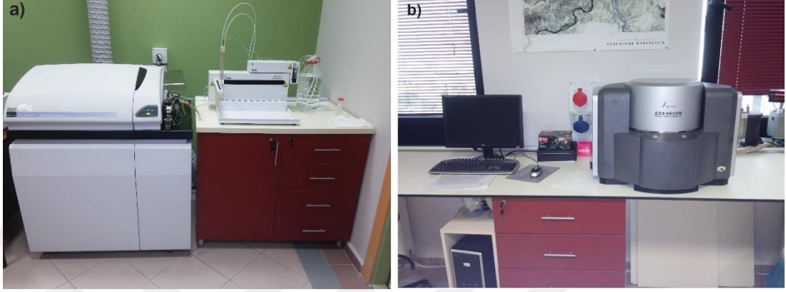
Şekil 1.4. KOU analitik jeokimya laboratuvarında tüm kayaç jeokimyası analizlerinin gerçekleştirildiği (a) Perkin Elmer Elan DRC-e model ICP-MS cihazları, (b) Skyray EDX3600B model ED-XRF
