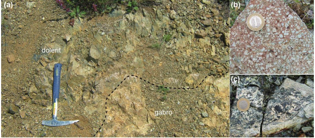
Şekil 3.9. (a) Kızıllalan köyünün ~4 km KD'sunda gabroları kesen dolerit daykının görünümü. Kızıllalan köyü kuzeyindeki gabroları kesen (b) porfirik dokulu daykının ve (c) makaslanmış gabroların yakından görünümü
