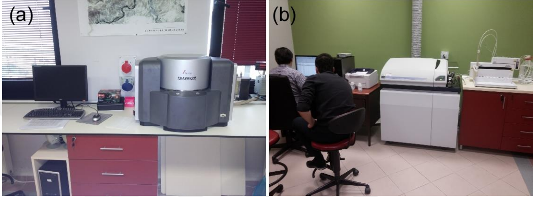
Şekil 1.3. KOU analitik jeokimya laboratuvarında tüm kayaç jeokimyası analizlerinin gerçekleştirildiği (a) Skyray EDX3600B model ED-XRF ve (b) Perkin Elmer Elan DRC-e model ICP-MS cihazları
