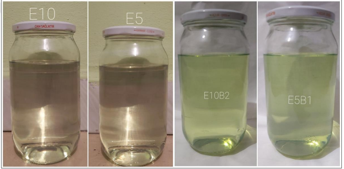
Şekil 3.1. Etanol-Dizel yakıt karışımlarına 2-bütanol etkisi
