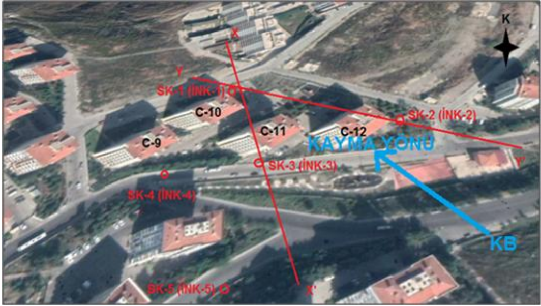
Şekil 5. 1. Açılan sondaj, inklinometre lokasyonları, kesit yönleri ve kayma yönü.
