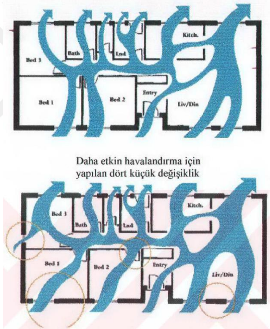
Şekil 3.24. Pencere yerleşiminin etkin havalandırmadaki önemi (Paolino S; aktaran Akin, 2001)
