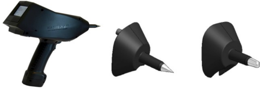
Şekil 4.23. a. ESD tabancası b. Temaslı darbe ucu c. Havadan darbe ucu
