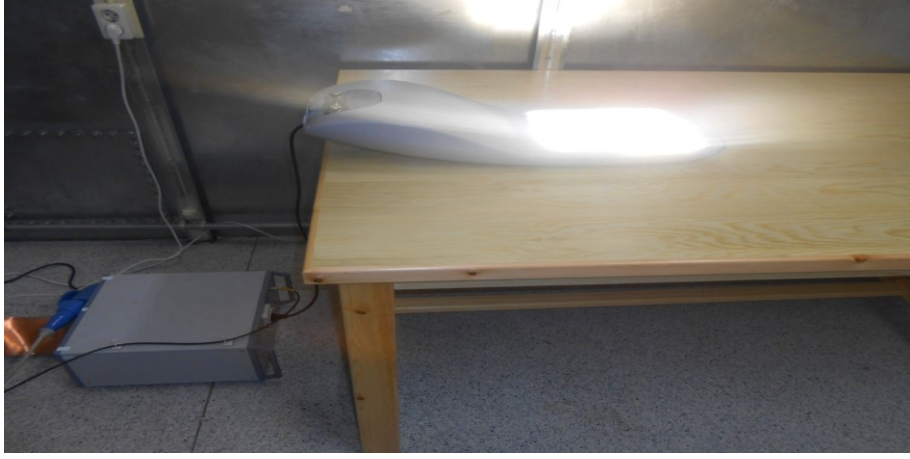
Şekil 6.6. AC LISN'in LED armatüre bağlantısı [68]
