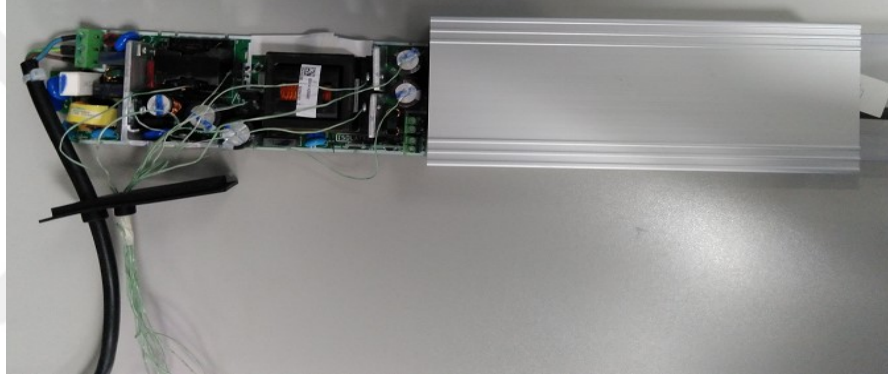
Şekil 6.2. Termokupl bağlı LED sürücü kartı ve kart kutusu [68]
