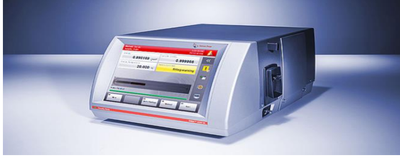
Şekil 4.2. Anton Paar DMA 500 yoğunluk ölçer
