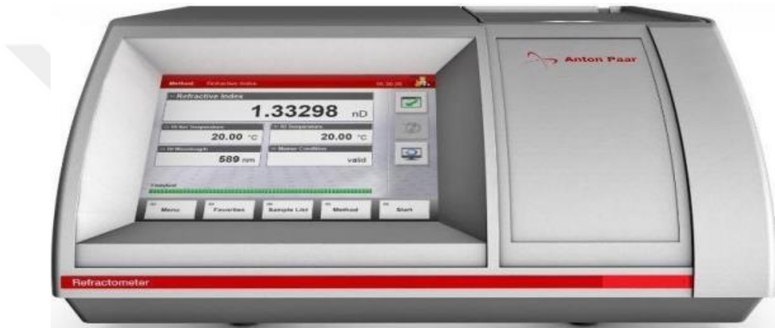
Şekil 4.1. Anton paar abbemat 200 dijital refraktometre
