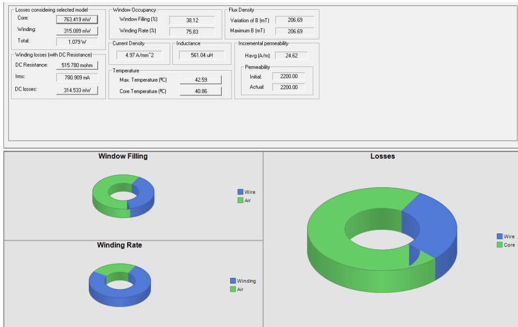
Şekil 2.23. 20x0.10 mm litz telli tasarımın kayıp analizi
