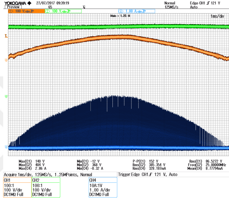
Şekil 3.21. Çıkış elektrolitik kapasitesi üzerinden ölçülen akım
