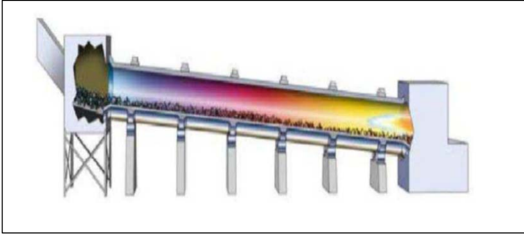
Şekil 1.14. Döner fırın ters akış prensibi [51]
