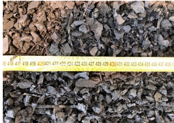
Şekil 2.22. İnce kıyılmış ömrünü tamamlamış lastik
