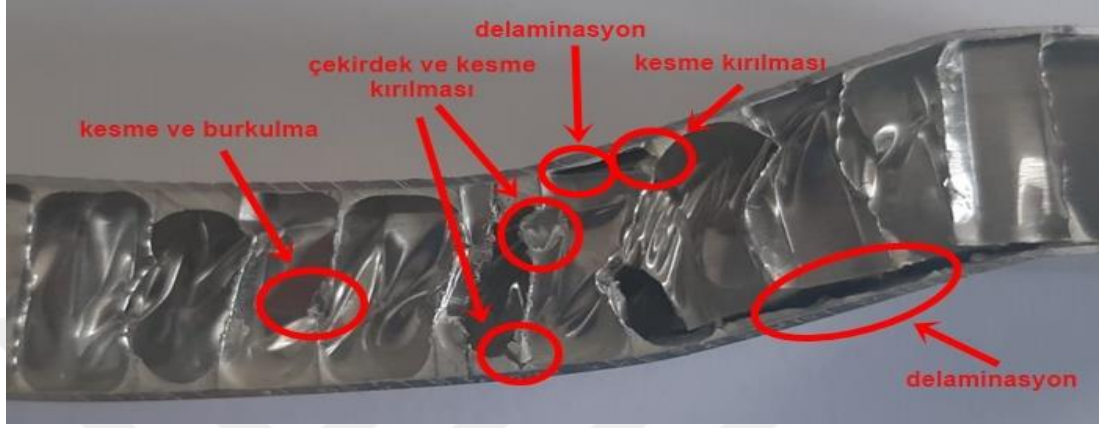
Şekil 3.8. Termal çevrime maruz bırakılmış bal peteği sandviç kompozitlerin (TÇ-300) hasar modları
