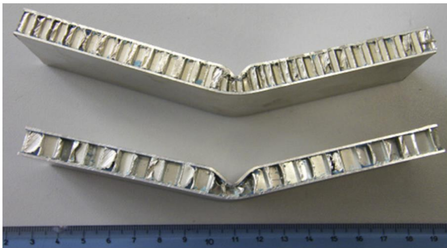
Şekil 1.28. Eğilme testi sonrası malzemedeki hasar mekanizması [55]
