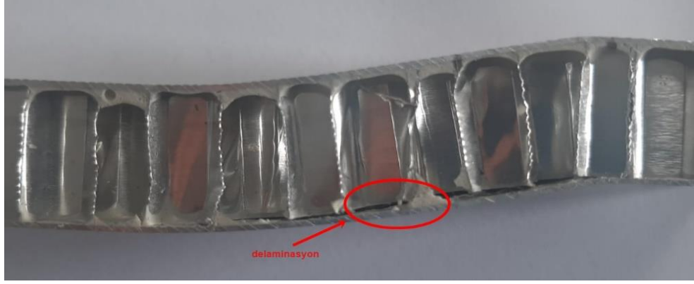
Şekil 3.6. Termal çevrime maruz bırakılmamış orijinal bal peteği sandviç kompozitlerin (TÇ-0) hasar modları
