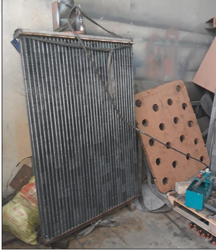
Şekil 4.26. Ön ısıtma bataryası 27 bar basınç testi
