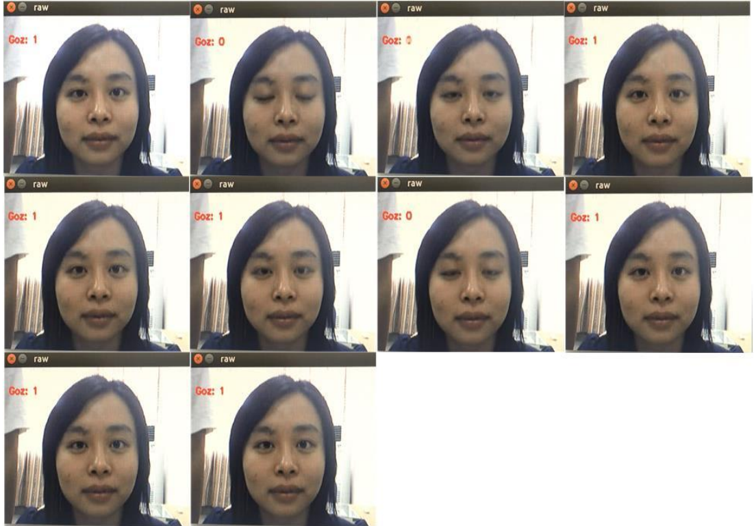
Şekil 4.103. Göz bilgileri için oluşturulan DBN (ZJU) modelinin testi için yorgun olmayan bir sürücüye ait rastgele seçilen 4 sn'lik videoda peşpeşe gelen 10 çerçevenin gösterimi
