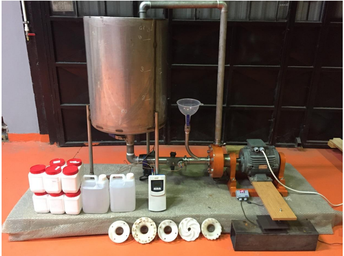
Şekil 3.14. Sürekli tip yüksek kayma gerilmeli karıştırıcı deney düzeneği
