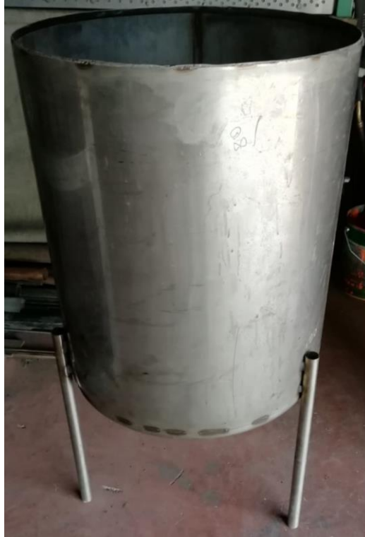
Őekil 4.8. Karıřım depolama tankı
