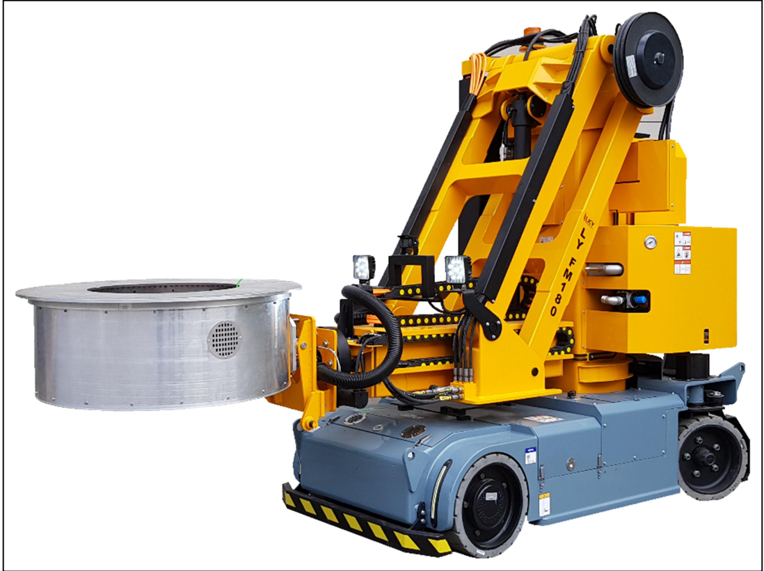
Şekil 3.27. Temizlik sepeti ve platform fiziksel prototipi
