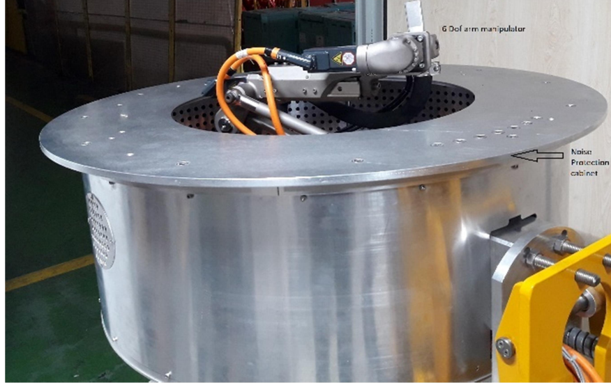
Şekil 3.26. Altı eklemlı robot ve temizlik sepeti fiziksel prototipi
