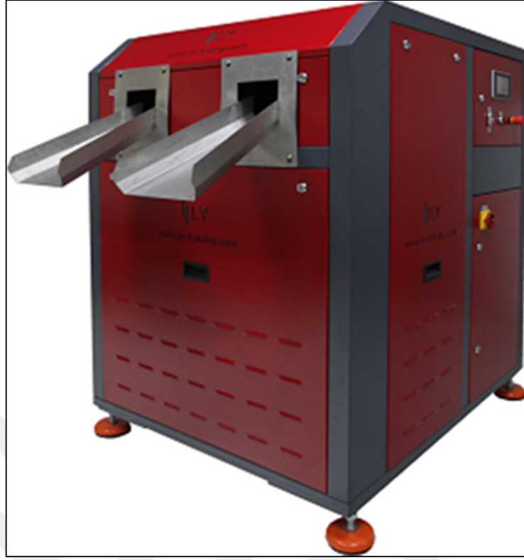
Şekil 1.1. Kuru buz üretim makinesi [1]
