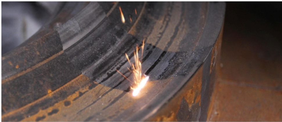
Şekil 1.7. Lazer ile oto lastiği yanak kalıbı temizliği
