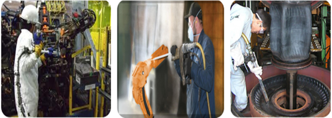
Şekil 1.5. Kuru buz ile yüzey temizleme örnekleri [2]
