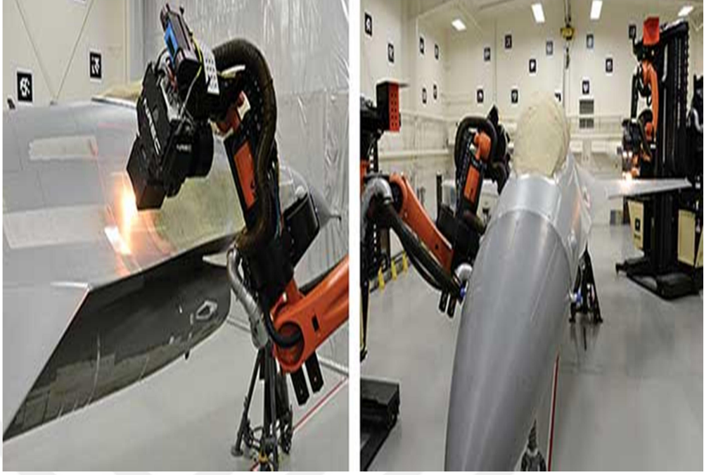
Şekil 1.9. Lazer ile robotik uçak gövde kaplama temizliği [4]
