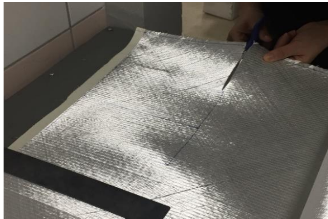
Şekil 3.2. Cam elyaf malzemenin işaretlenen ölçülerde kesilmesi
