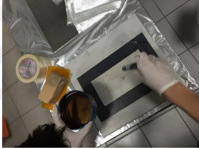
Şekil 3.3. Kalıp içerisine yerleştirilen cam elyaf üzerine reçinenin yedirilmesi
