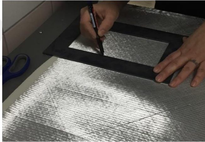
Şekil 3.1. Cam elyaf malzemenin kalıp ölçülerinde işaretlenmesi
