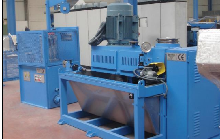
Şekil 3.8. Sulu tel çekme makinesi [14]
