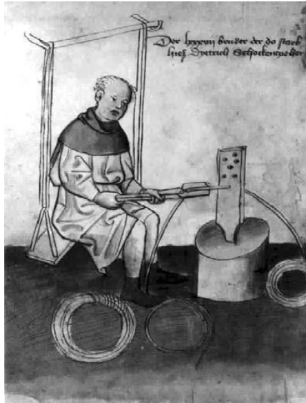
Şekil 1.1. Geçmişte tel çekme işleminin yapılışı [7]
