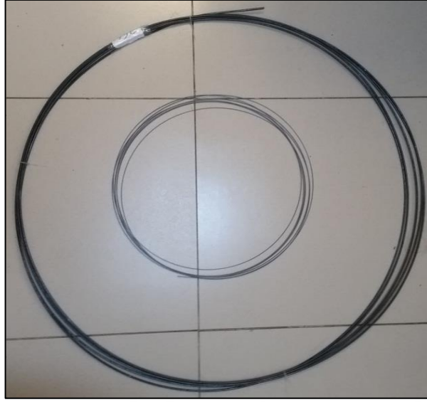
Şekil 6.1. Deneylerde kullanılan çelik filmaşın ve nihai çelik tel numuneleri
