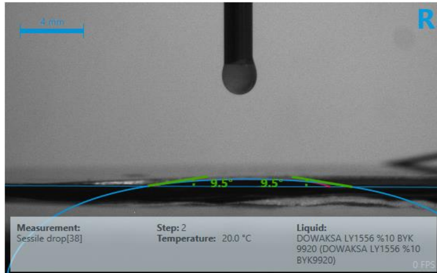
Şekil 4.2. Reçinenin elyaf üzerinde düştüğü andan 1 dakika sonraki temas açısı ölçümü
