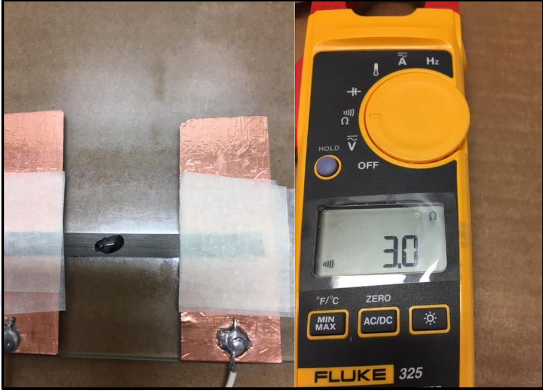
Şekil 4.16. Üzerine reçine damlatılan elyafın devredeki direnç ölçümü
