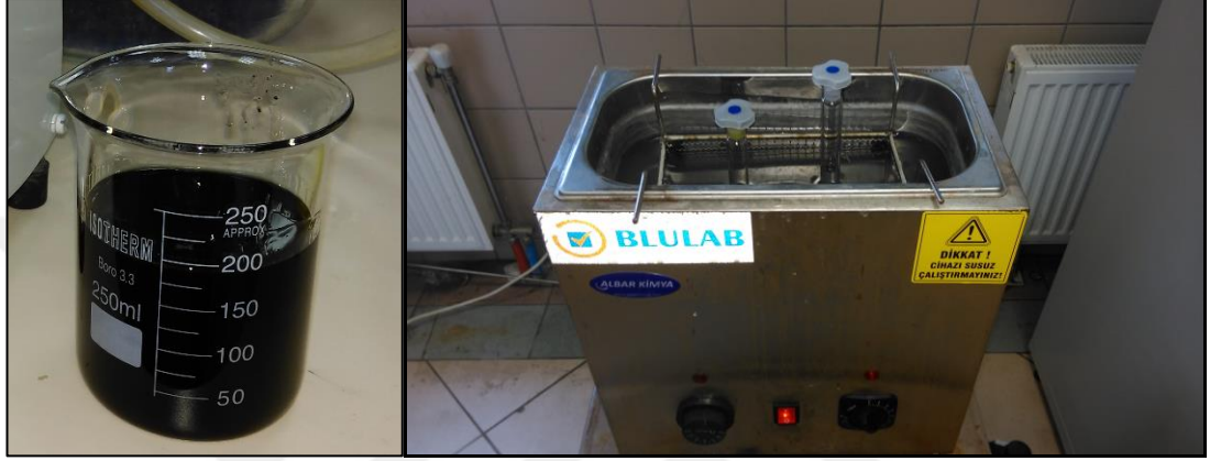
Şekil 2.1. Elektrokatalizör reaksiyon sistemi 1. Isotherm marka beher 2. Blulab marka ultrasonik banyo
