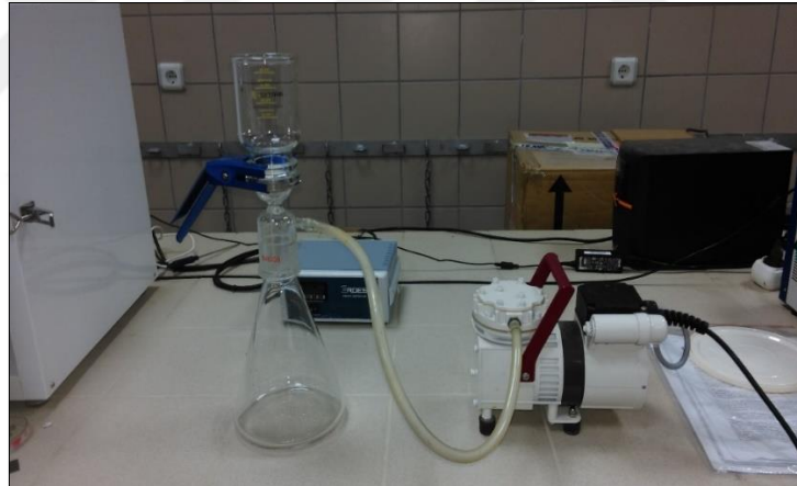
Şekil 2.3. Vakum filtrasyon seti ve vakum pompası
