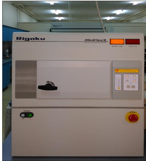
Şekil 2.5.Rigaku MiniFlexII XRD cihazı
