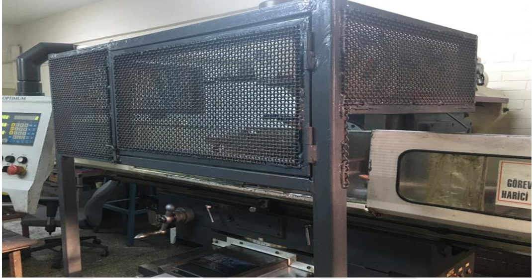
Şekil 4.4. Risk Değerlendirme sonrası elle açılır ancak interlok olmayan deneme muhafaza kapısı yapılan Optimum yatay freze tezgahı
