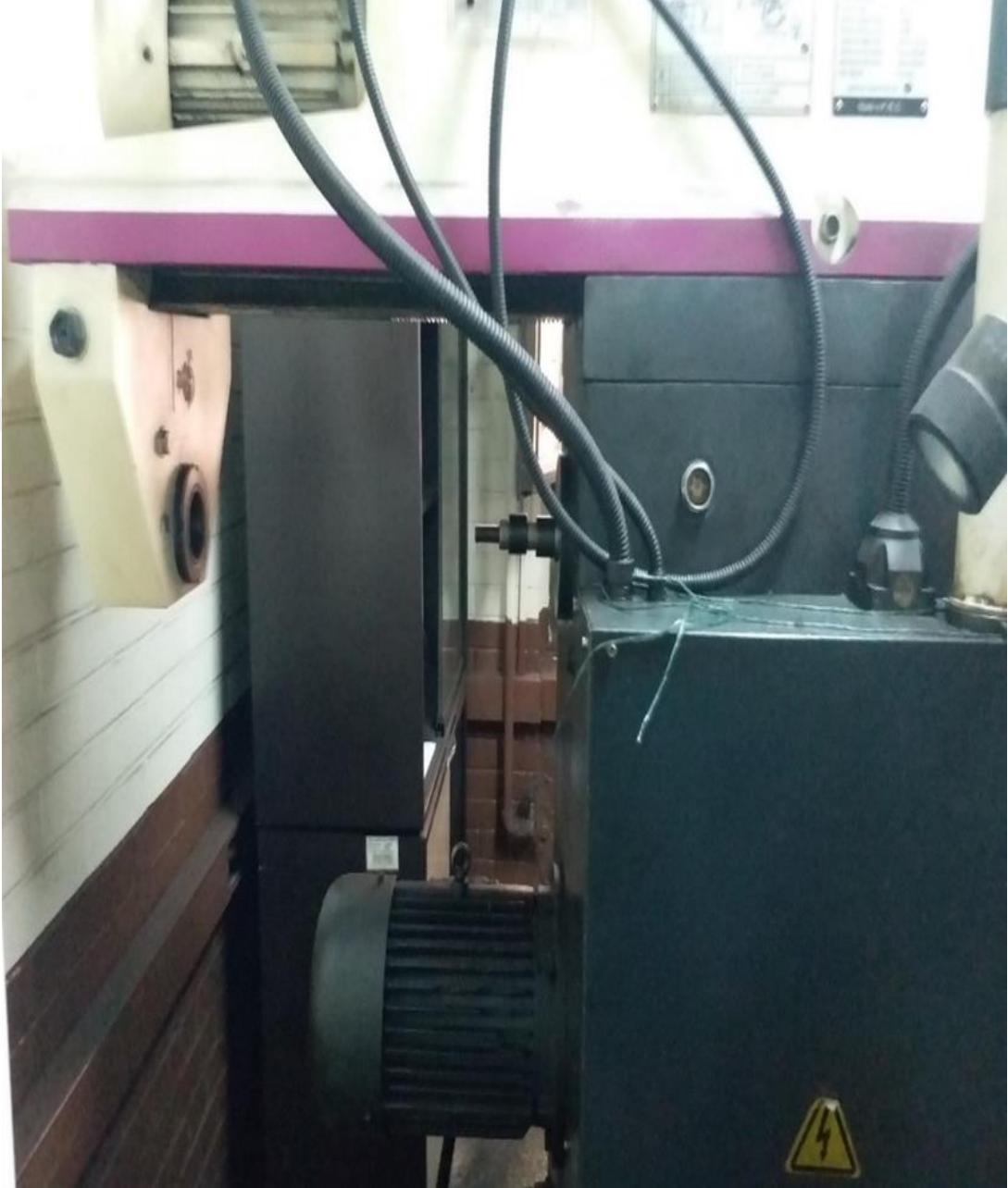
Şekil 4.6. Risk Değerlendirme sırasında tespit edilen tezgah arkasında muhafazası olmayan hareketli mile sahip Optimum yatay freze tezgahı
