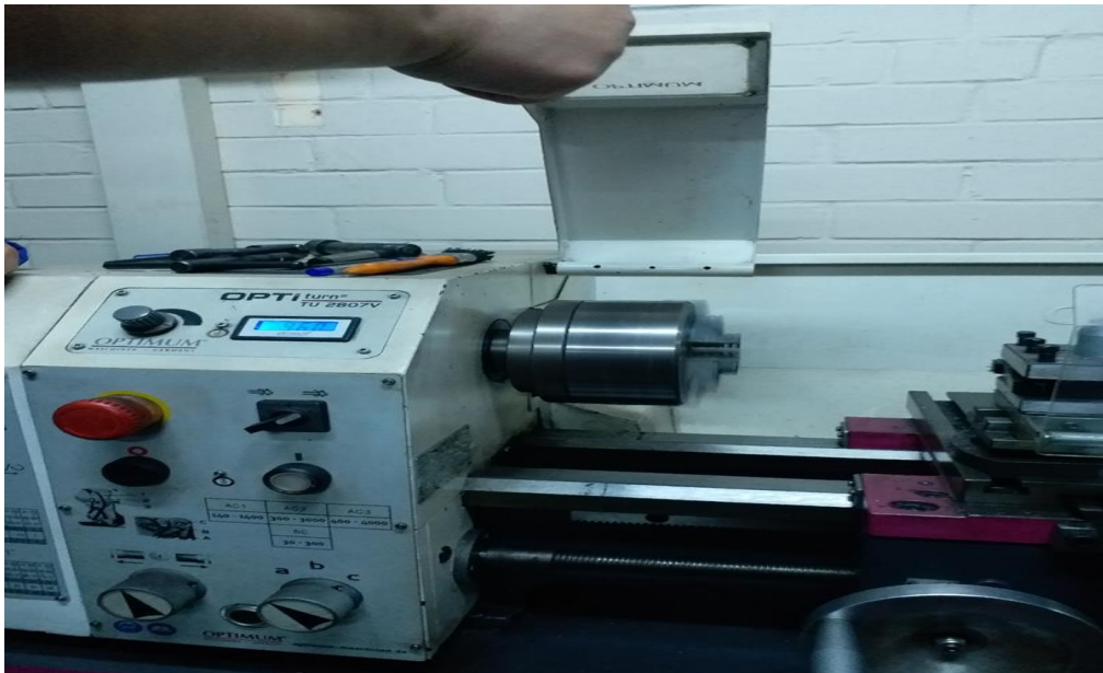
Şekil 4.2. İnterlok muhafaza kapağı ile çalışan örnek torna tezgahı (kapak kaldırıldığında ayna dönüşü durmakta)
