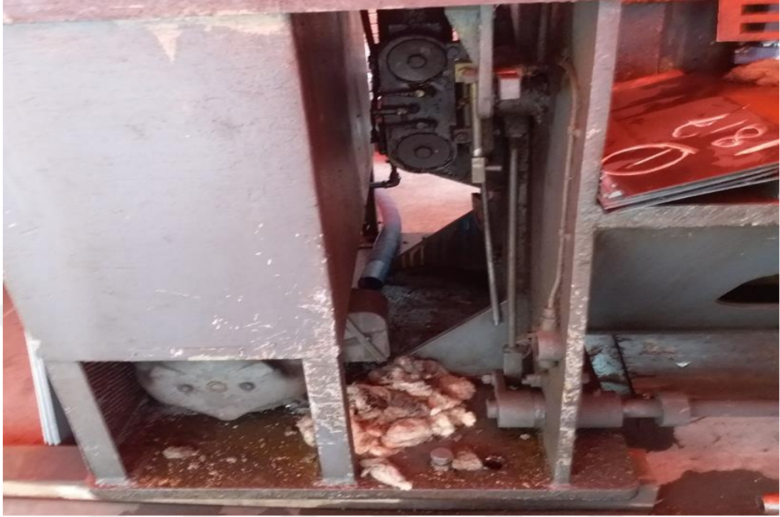
Şekil 4.8. Risk Değerlendirme sırasında tespit edilen, dönen ekipmanların üzerinde muhafaza kapağı olmayan Rhodes giyotin makas tezgahı
