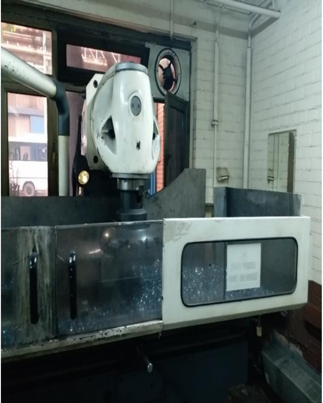
Şekil 4.3. Risk Değerlendirme öncesi orijinal ancak yetersiz, işleme alanını sınırlayan muhafaza kapısı olan Optimum yatay freze tezgahı
