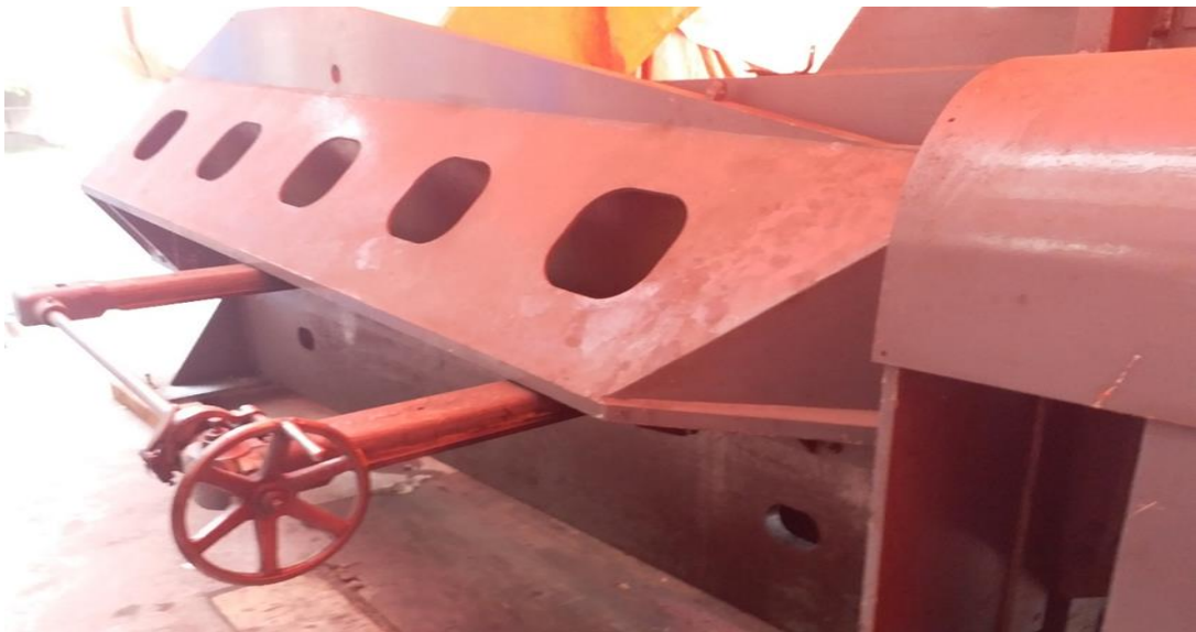
Şekil 4.9. Risk Değerlendirme sırasında tespit edilen, tezgah arkasına geçişin sınırlandırılmadığı Rhodes giyotin makas tezgahı
