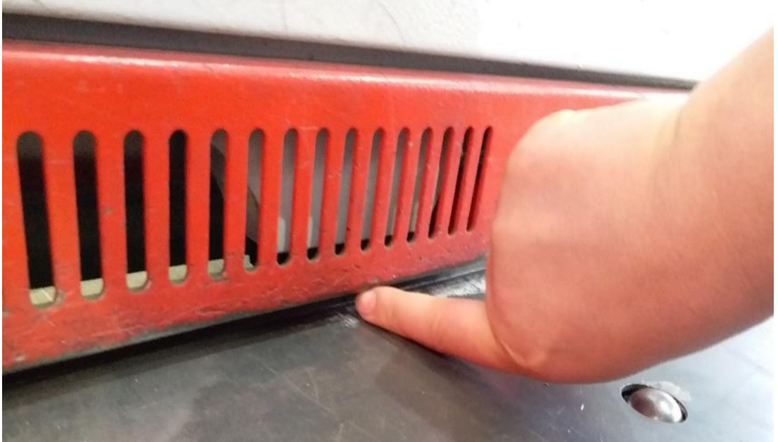
Şekil 4.11. İnterlok ve hareketli muhafaza kapağı ile kesme alanı sınırlandırılan örnek giyotin makas tezgahı
