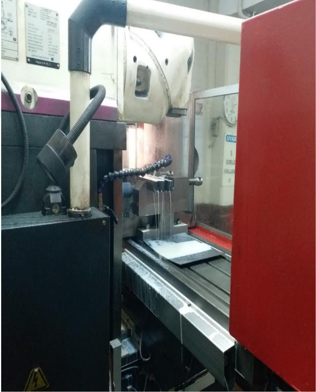
Şekil 4.7. Risk Değerlendirme sırasında tespit edilen tezgah arkasında iş parçası veya işleme takımlarının fırlayıp etkileyebileceği alana sahip Optimum yatay freze tezgahı
